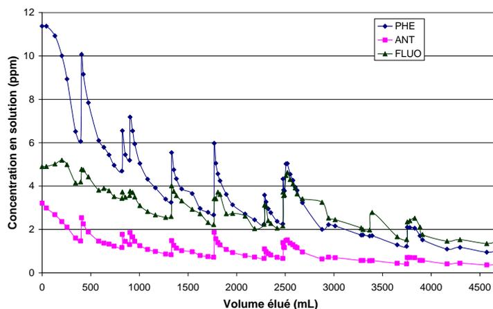
fig. 2. 50g de sol 4, élué de HPCD à 20 g.L<sup>-1</sup>, débit variable (0-2500 mL: 0.9 mL.min<sup>-1</sup>, >2500 mL: 0.28 mL.min<sup>-1</sup>)
