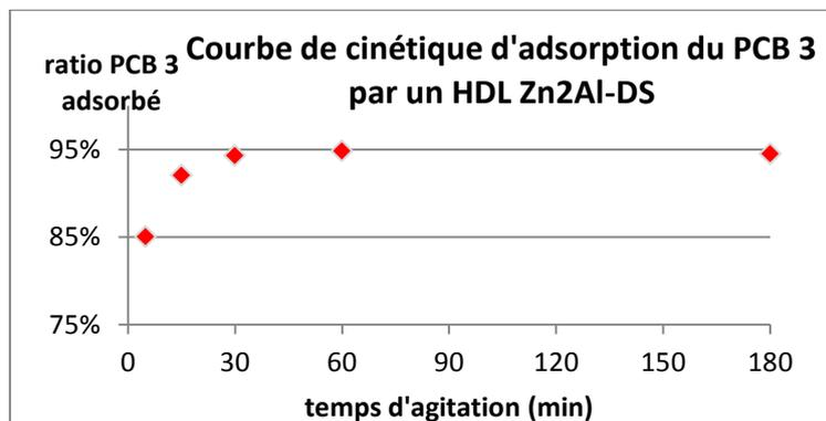
Figure 8 : Courbe cinétique d'adsorption du PCB 3
