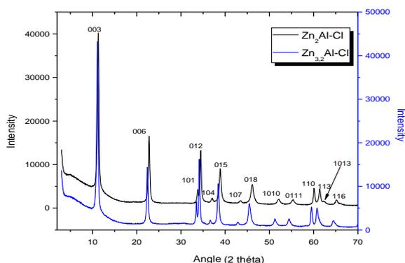
Figure 4 : Diffractogrammes de rayons X des phases ZnAl-Cl
