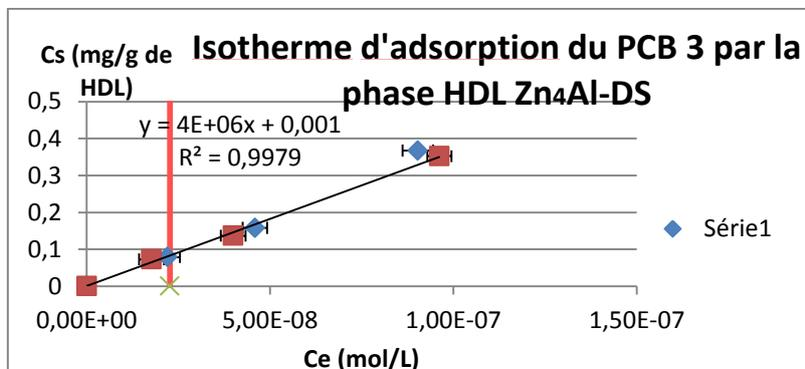
Figure 9 : Exemple d'isotherme d'adsorption du PCB 3 sur un HDL organomodifié
