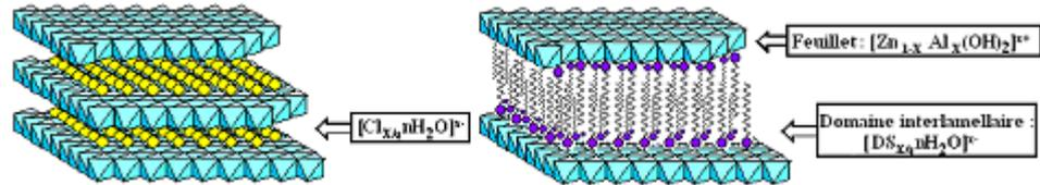
Figure 6 : Schéma de l'espace interlamellaire suivant l'espèce intercalée
