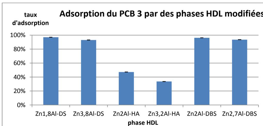
Figure 10 : Capacité d'adsorption du PCB 3 par des HDL organomodifiés
