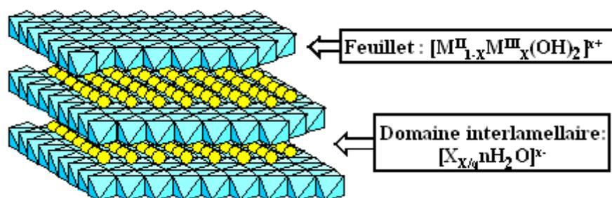
Figure 3 : Structure schématique des HDL [FORANO, 2006]
