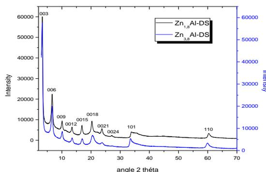
Figure 5 : Diffractogrammes de rayons X des phases ZnAl-DS
