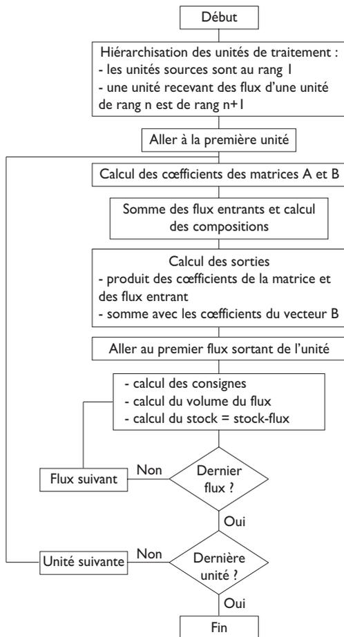
**Figure 3 : Algorithme simplifié des calculs effectués à chaque pas de temps**
