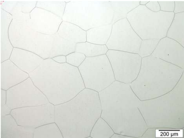
FIG. 8. Microstructure of pure iron.
