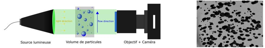
Acquisition d'images 2D de l'écoulement<sup>[1]</sup>
