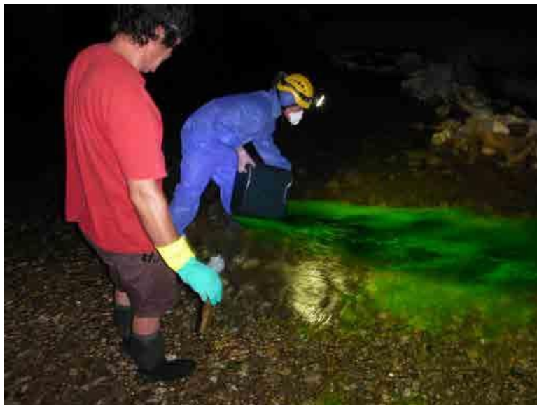
Photo 4 : Injection de 10kg de fluorescéine dans la Cèze, au pont de Rivières soit 500m environ en amont de la coupure des écoulements superficiels, le 21 juillet 2015 à 00h00 ( photos: Jordan Ré-Bahuaud)
