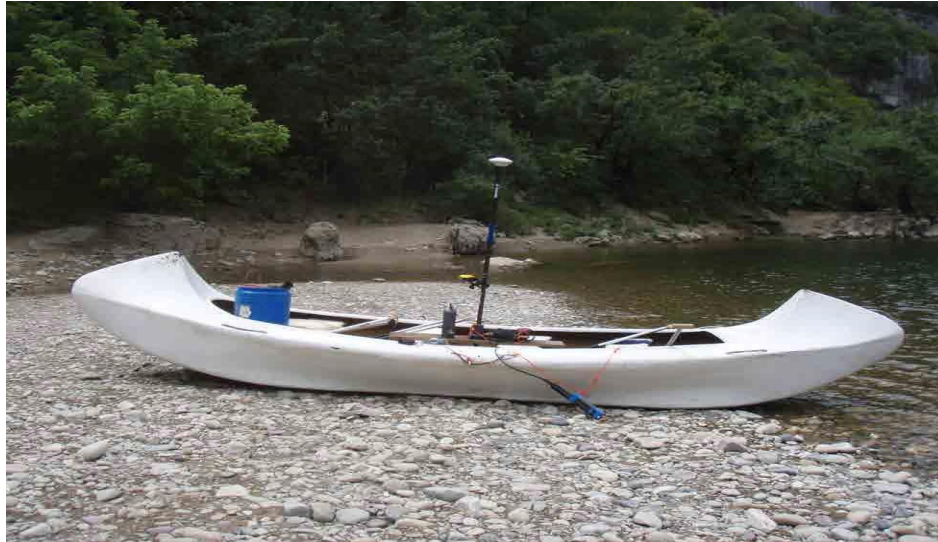
Figure 1: Dispositif embarqué sur canoë pour la réalisation d'un profil longitudinal de la Cèze avec mesure de la température et la conductivité de l'eau de la rivière (photo: J. Jolivet) Canoe-mounted device for the realization of a longitudinal profile of the Cèze with temperature measurement and water conductivity of the river.
