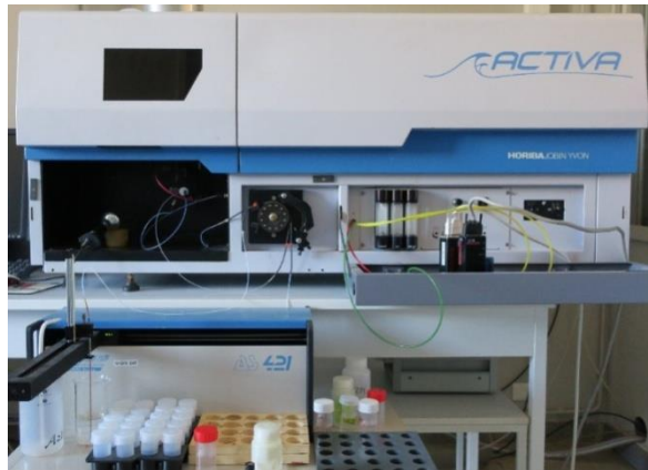
Photo2 : Analyse par Spectrométrie d'Emission Atomique à Source Plasma (ICP-AES) Analysis by Spectrometry of Atomic Emission at Source Plasma(ICP-AES)
