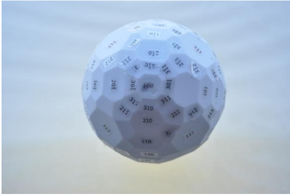
Figure 7. Pièce réalisée par impression 3D à partir du modèle numérique. Diamètre 65mm.
