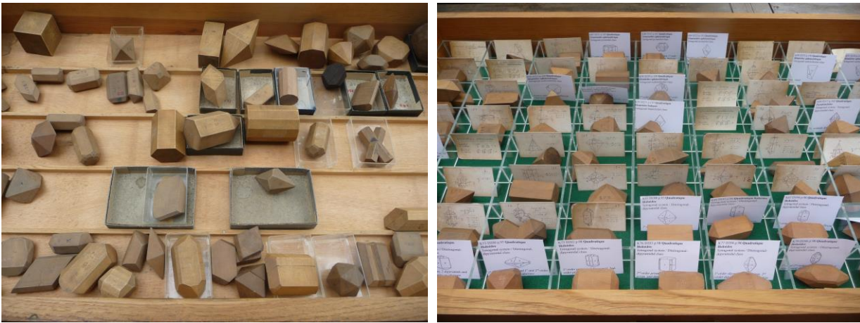
Figures 1 et 2. Quelques modèles cristallographiques en bois de l'École des Mines de Saint-Etienne, avant (à gauche) et après (à droite) restauration. La plus grande dimension des modèles est d'environ 50mm.
