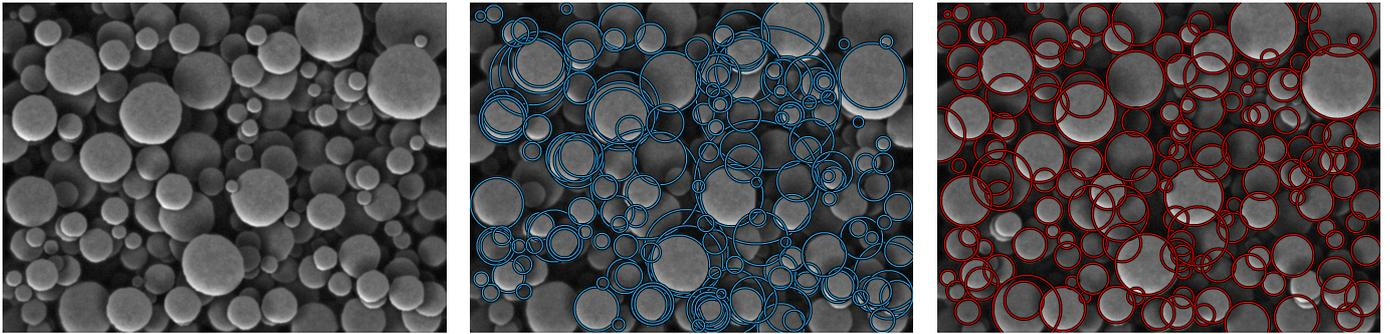
FIGURE 3 : Comparaison visuelle des résultats des deux méthodes de segmentation sur un exemple d'image synthétisée à l'aide du modèle de simulation aléatoire développé. De gauche à droite : Image aléatoire simulée (gauche), segmentation de l'image par la méthode basée sur la CHT d'ImageJ Particle Sizer (centre), et segmentation par la méthode CAM proposée (droite).
