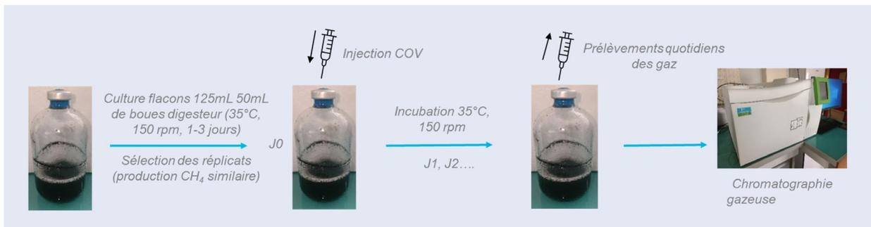
Pour réaliser les essais (Figure 28), des boues de digesteur anaérobie issues de la station d'épuration MAERA<sup>39</sup> de Montpellier ont été utilisées comme source microbienne (inoculum) et placés en conditions anaérobies (sans  $\text{O}_2$ ), sous agitation et à 35°C, en présence d'un gaz synthétique (20 %  $\text{CO}_2$  + 80 %  $\text{H}_2$ ) à une pression de 1,2 bar.
