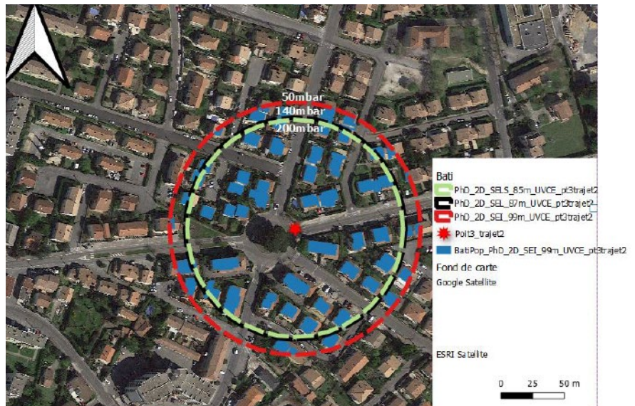
FIGURE 35 Exemple de simulation d'effets de surpression d'une perte de confinement, sur un trajet et point sensible donné, permettant d'estimer le nombre de personnes exposées.
