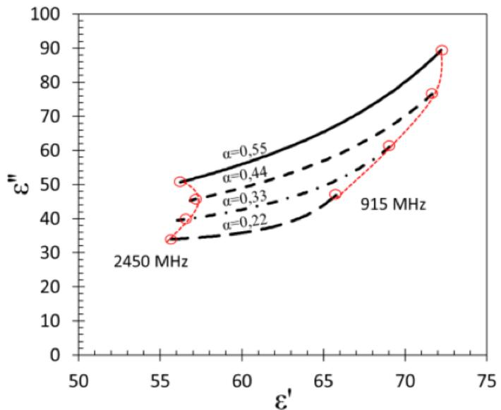
Les études menées pour HyTREND ont permis de mesurer les variations du facteur de perte caractérisant l'aptitude du solvant à dissiper sous forme de chaleur l'énergie électromagnétique, et celles de la constante diélectrique fonction de la fréquence (915-2450 MHz), de la température et de la charge en CO<sub>2</sub>.
