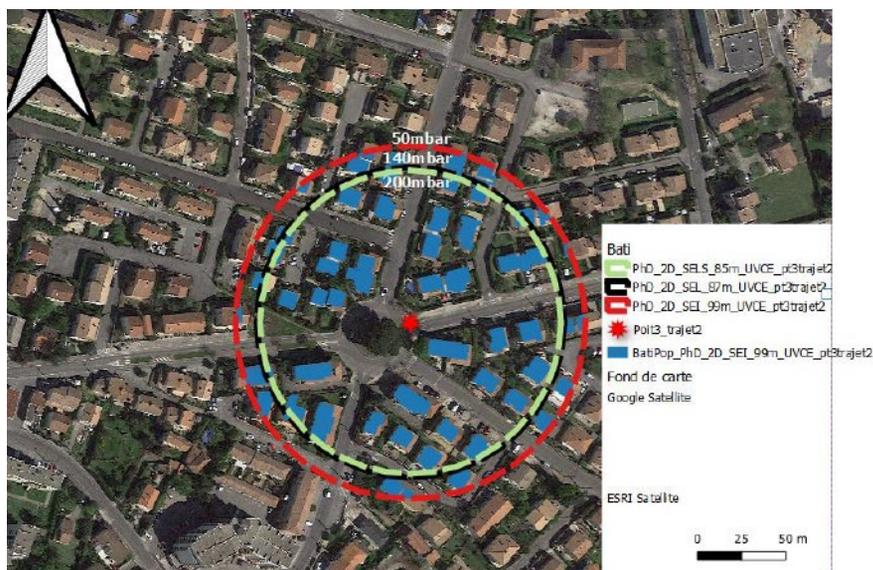
À partir de cette analyse, différents phénomènes dangereux (fuite d'hydrogène due à la fragilisation de matériau, perte de confinement, feu de torche, etc.) ont été simulés sur les installations de production, de stockage et de transport d'hydrogène, en identifiant les itinéraires de transport et les points de vulnérabilité (en fonction de la densité de population).
