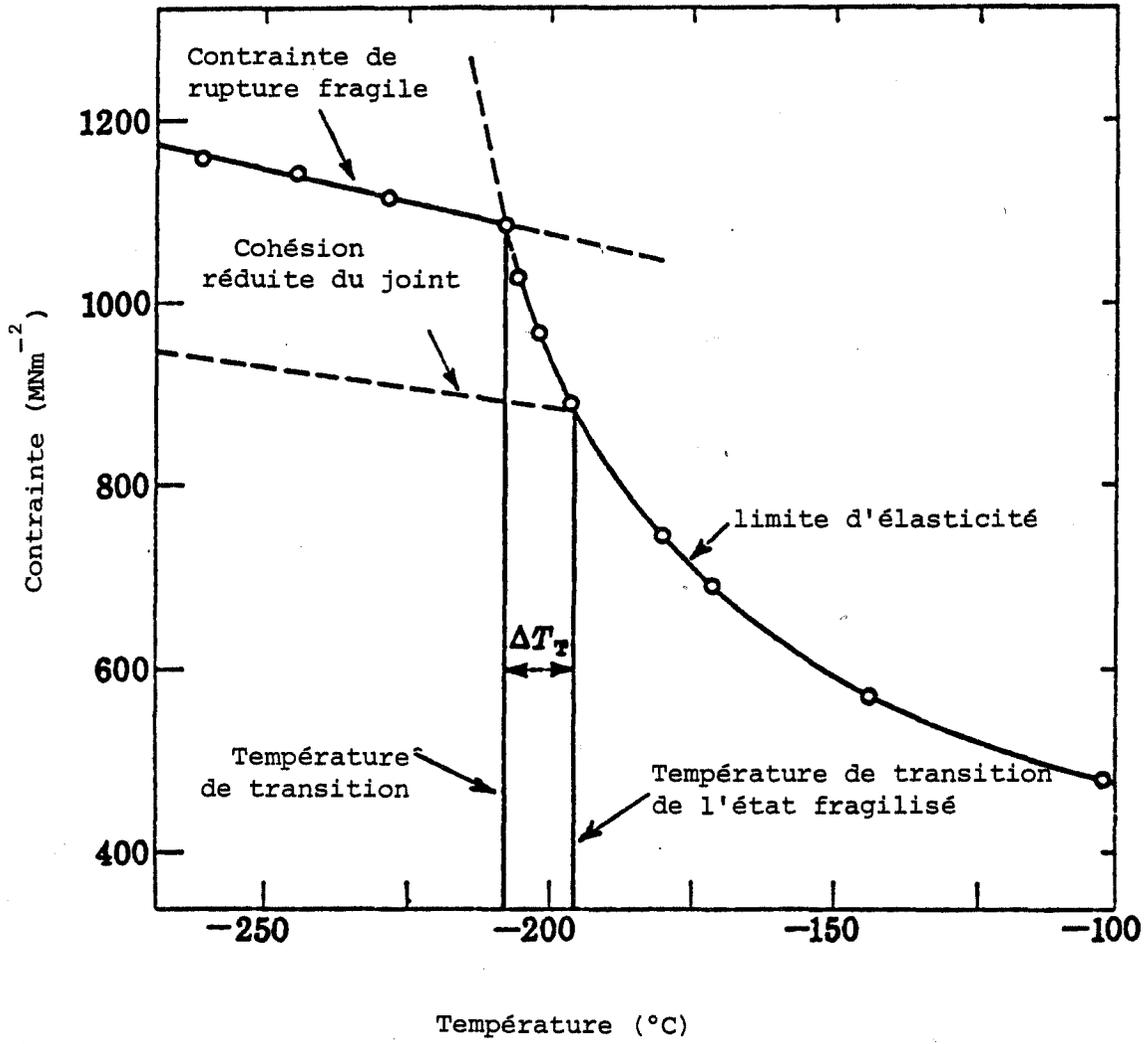
FIG.5 : Variation des caractéristiques mécaniques d'un acier au Mn-Sb à la suite d'un revenu à 500°C. (28).
