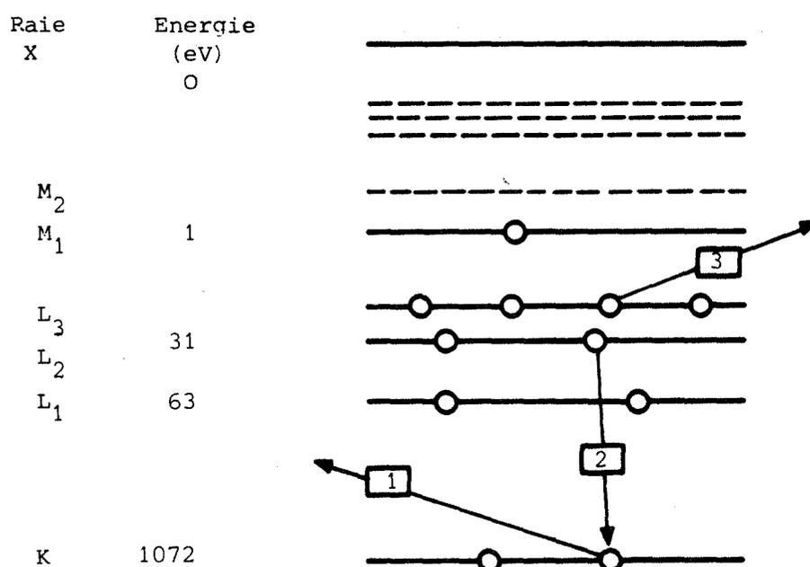
FIG.46 : La transition AUGER K L<sub>2</sub> L<sub>3</sub> du Sodium.
