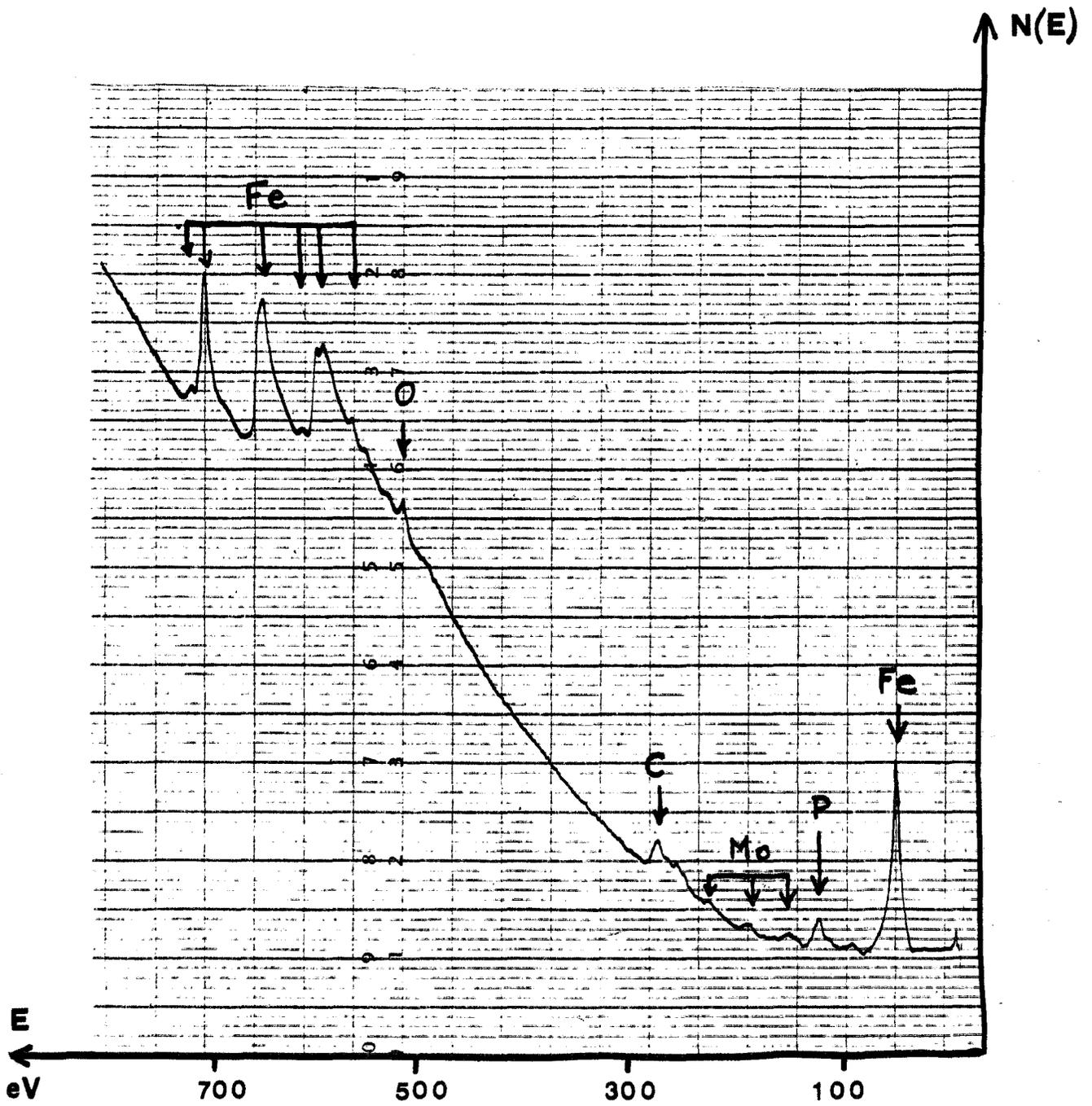
FIG.59 : Spectre AUGER direct - coulée 3 (P : 180ppm - Mo : 1,1%).
