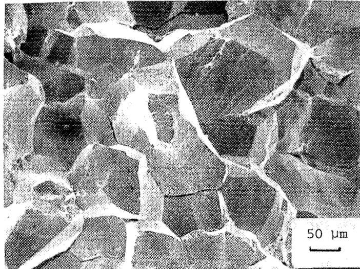
FIG.67 : Faciès de rupture intergranulaire - coulée 1 (P : 180ppm, Mo:0%)
