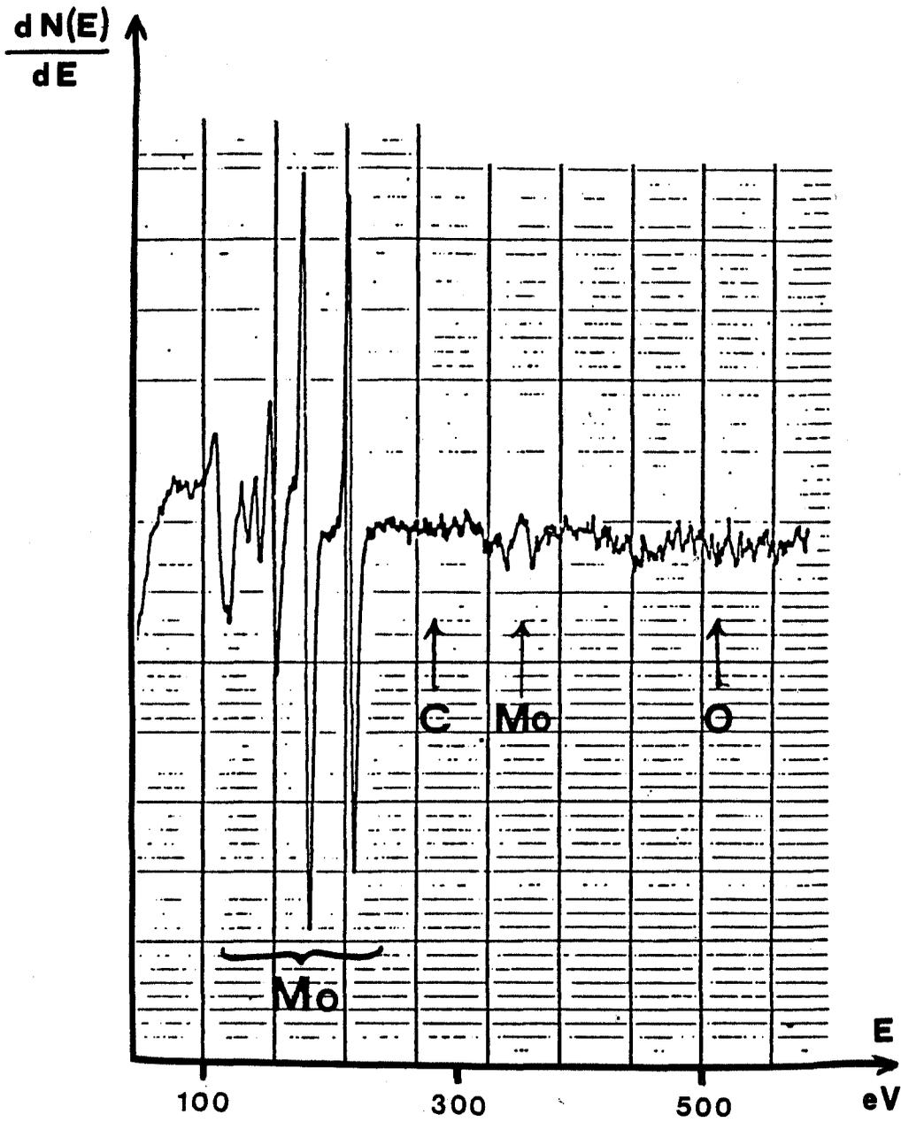
FIG.62 : Spectre AUGER dérivé du molybdène pur.
