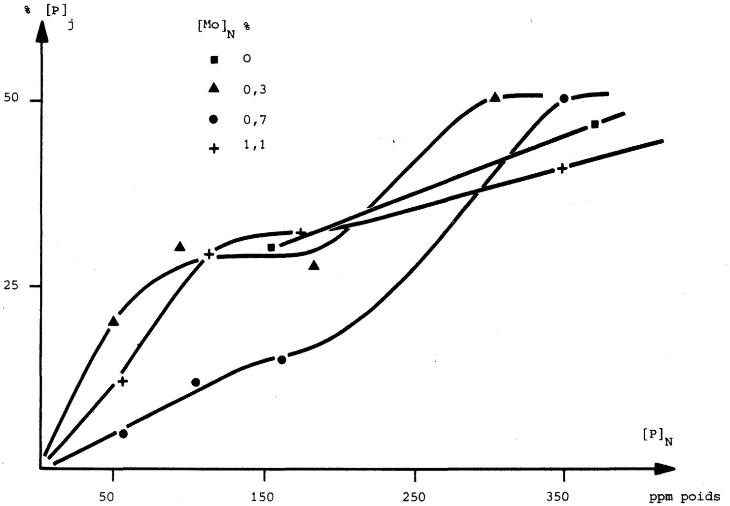
FIG.73 : Evolution de la ségrégation du phosphore avec sa concentration nominale dans l'état F<sub>1</sub>.
