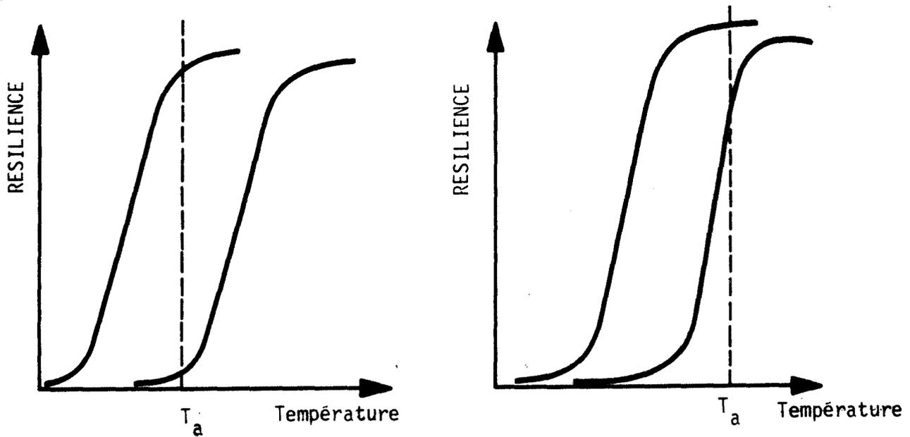
FIG.6 : Principe de détection de la fragilisation par revenu critiqué par JOLIVET et VIDAL (d'après 31).
