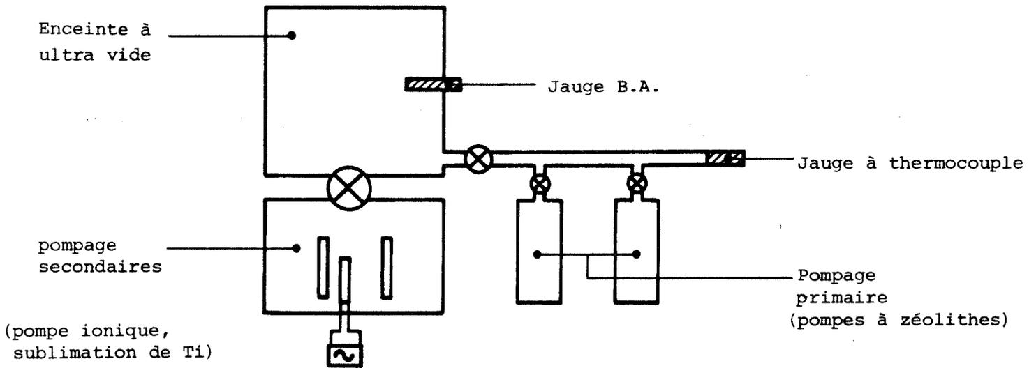
FIG.49 : Schéma de l'enceinte ultra vide initiale
