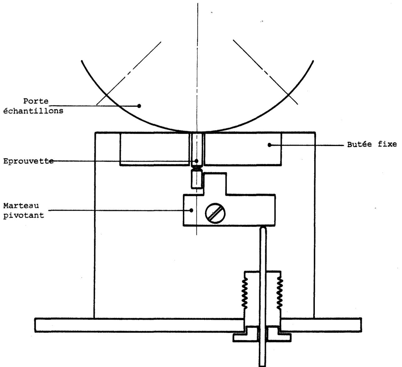
FIG.55 : Schéma de principe du fractureur.
