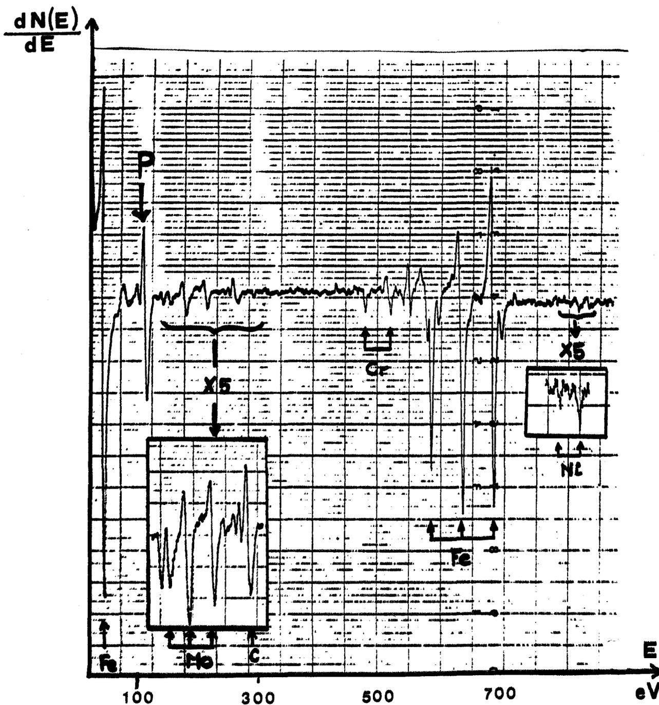
FIG.68 : Spectre AUGER dérivé - coulée 7 (P : 360ppm - Mo : 1,1%)
