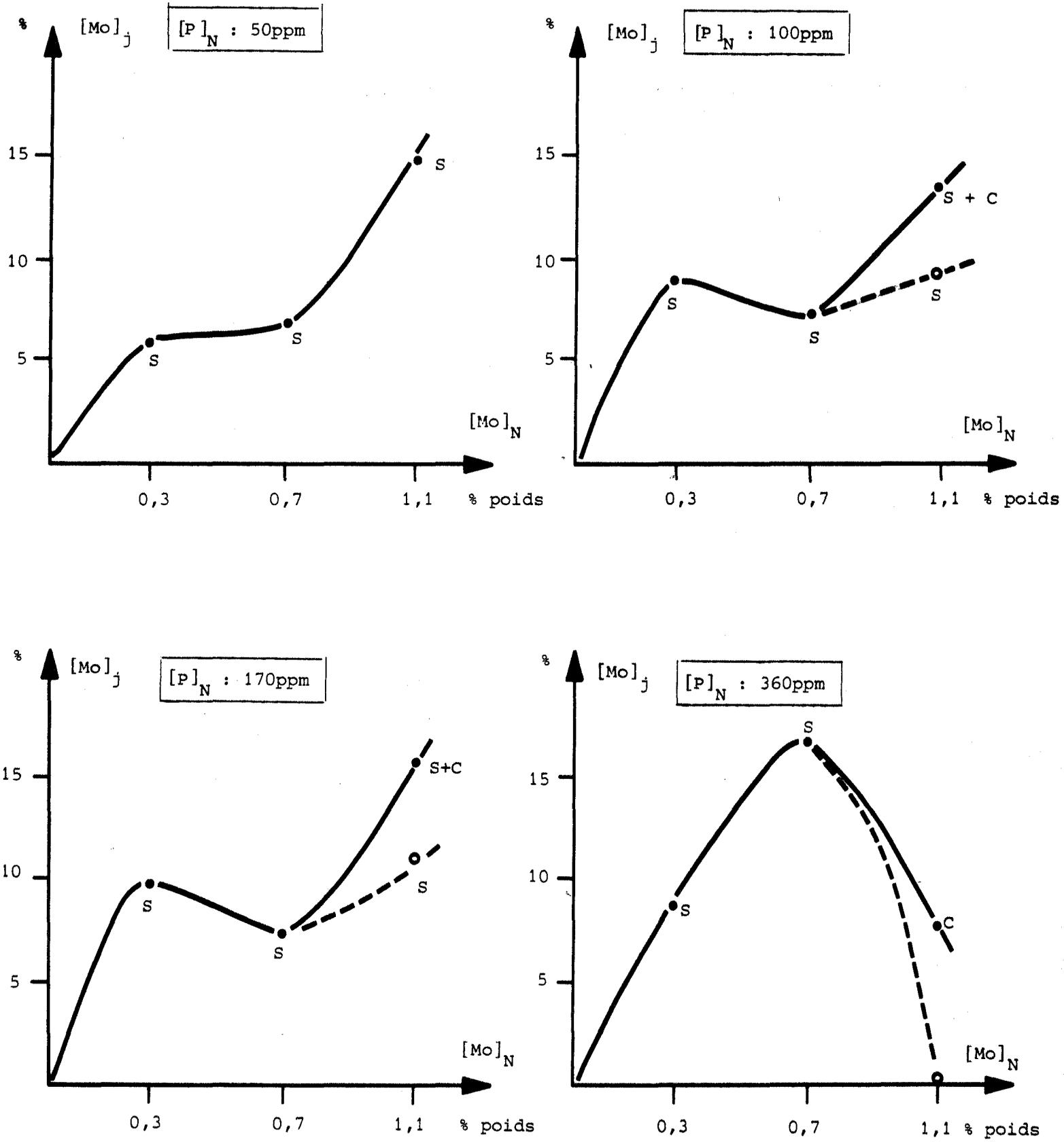
FIG.75 : Evolution de la concentration intergranulaire en Mo avec sa concentration nominale dans l'état  $F_1$ .
