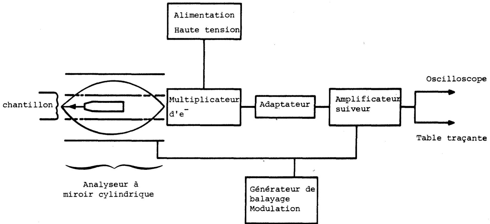
FIG.56 : Schéma de principe de la chaîne de traitement du signal.
