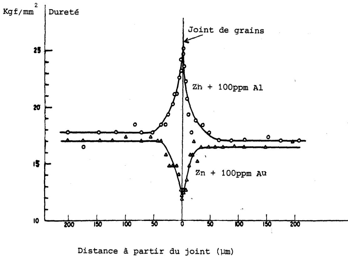
**FIG.29** : Evolution de la microdureté au voisinage d'un joint de grain de Zn où a ségrégé Au ou Al (42)
