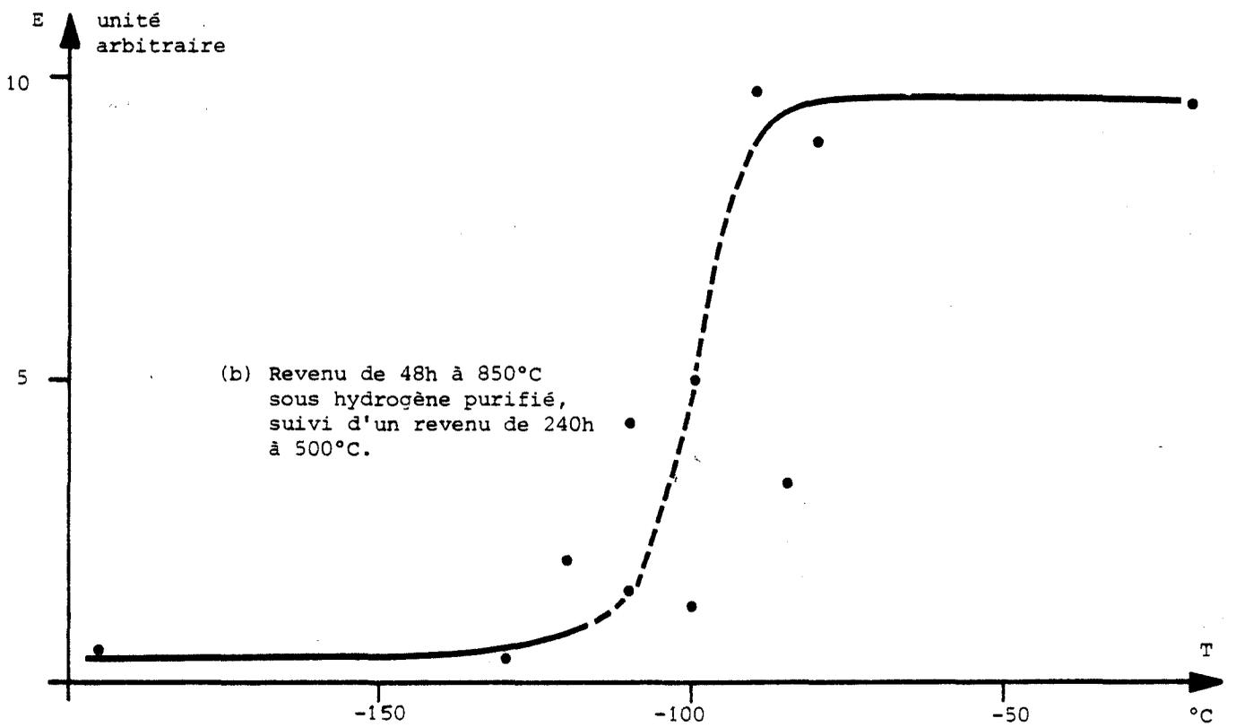
FIG.78 : Courbes de transition de l'alliage A (Fe-P).
