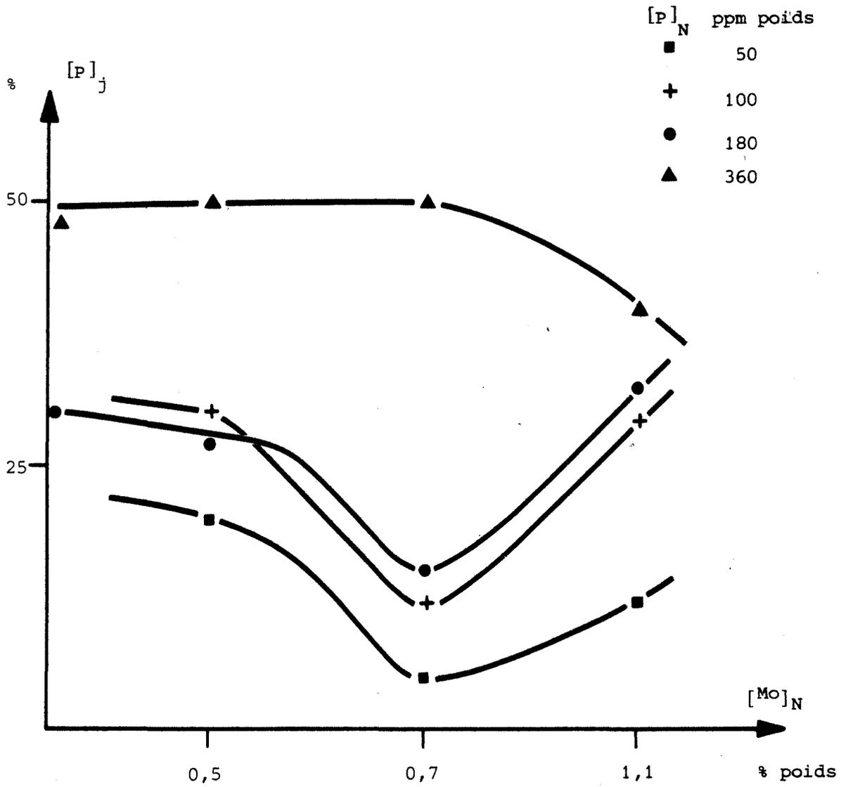
FIG.74 : Evolution de la ségrégation du phosphore avec la concentration nominale en molybdène dans l'état  $F_1$ .
