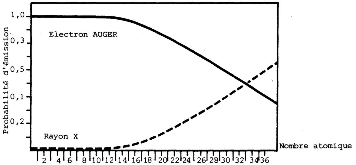
FIG.47 : Probabilité d'émission d'un photon X ou d'un électron AUGER suivant l'élément émetteur.
