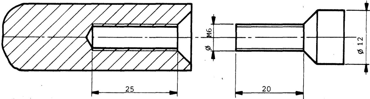
FIG.77 : Lingot usiné pour addition de phosphore.
