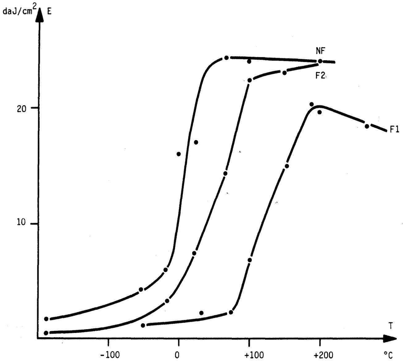
FIG.20 : Courbes de transition des états NF, F<sub>1</sub> et F<sub>2</sub> de la coulée n°7.
