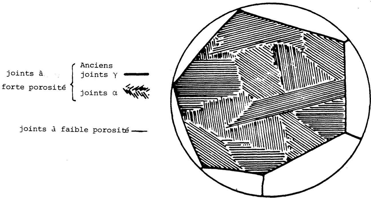
FIG.36 : Les différents types d'interface dans l'état trempé revenu (15)
