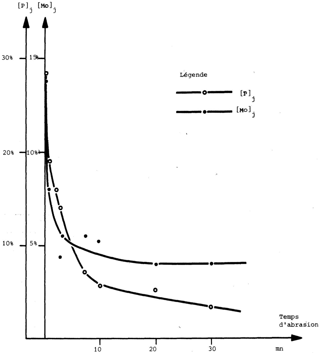
FIG.71 : Profil d'abrasion ionique : Coulée 7, contenant 360ppm et 1,1%Mo, P ségrégué, Mo ségrégué et précipité
