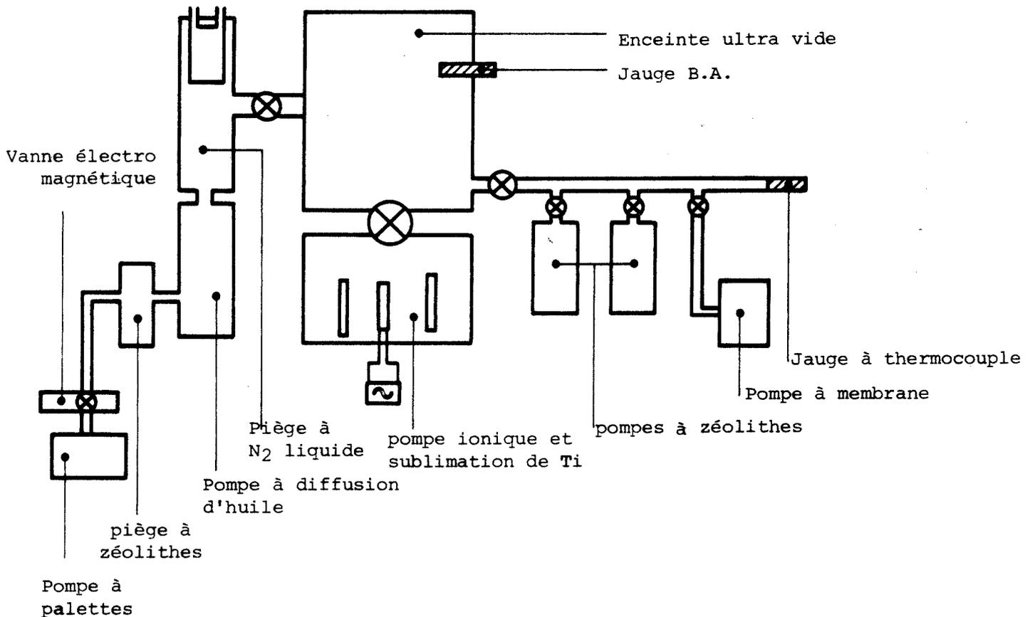
FIG.50 : Schéma de l'enceinte ultra vide après modifications.
