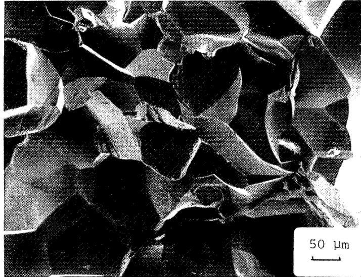
FIG.79 : Faciès de rupture à basse température, après traitement de décarburation et ségrégation de P pendant 240h à 500°C. Alliage A (Fe-P).
