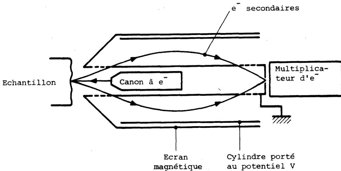
FIG.48 : Schéma de principe de l'analyseur à miroir cylindrique.
