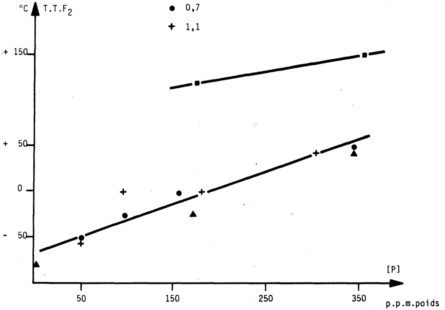
FIG.23 : Températures de transition T.T.F<sub>2</sub> fonction de la concentration nominale en P.
