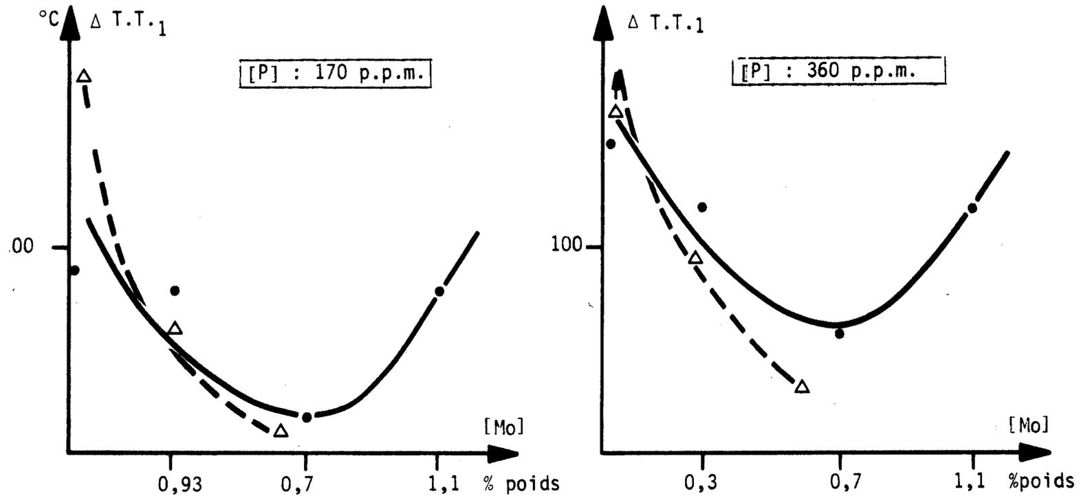
FIG.28 : Ecart  $\Delta T.T.1$  fonction de la concentration nominale en Mo.
