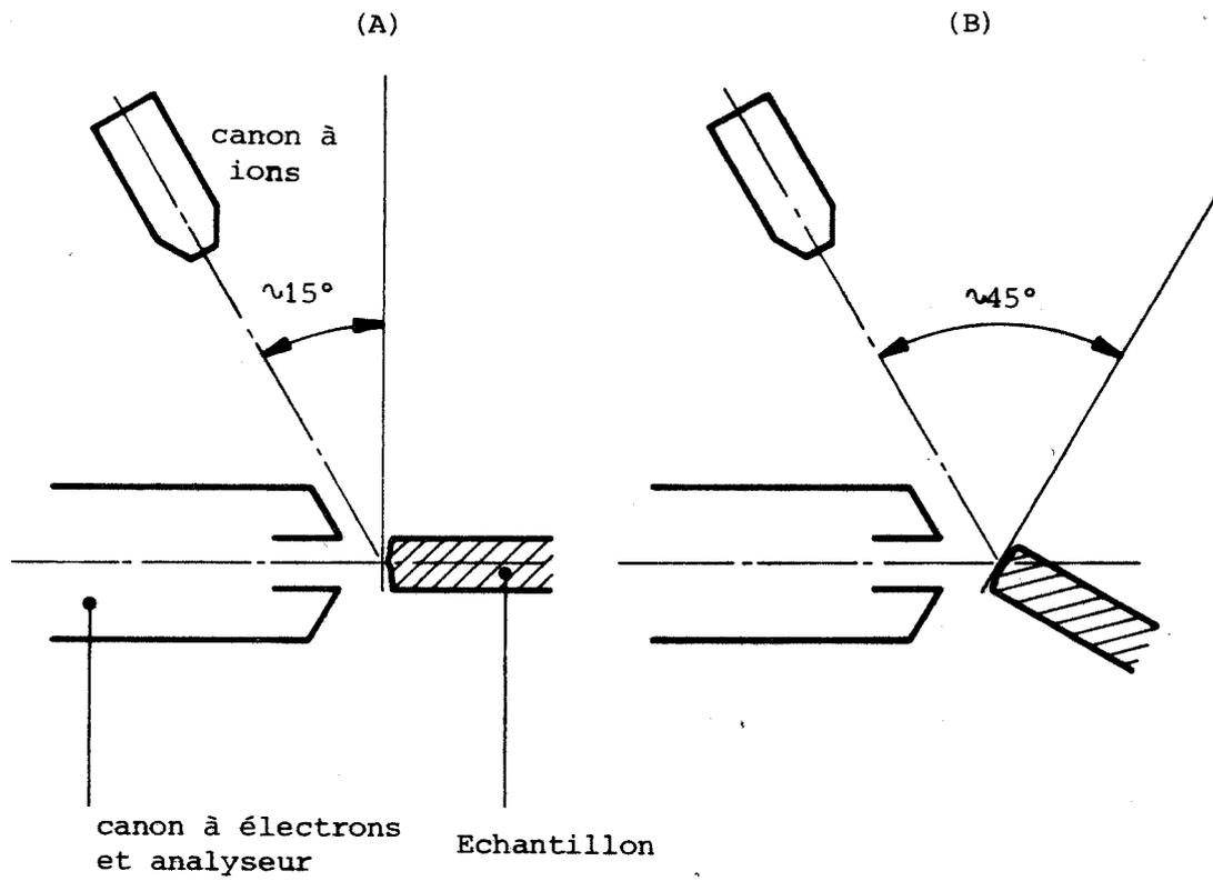
FIG.57 : Schéma d'implantation du canon à ion
