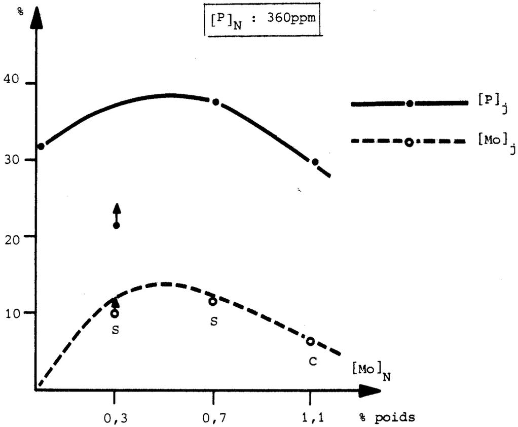
FIG.76 : Evolution des concentrations intergranulaires en P et Mo avec la concentration nominale en Mo dans l'état F<sub>2</sub>.
