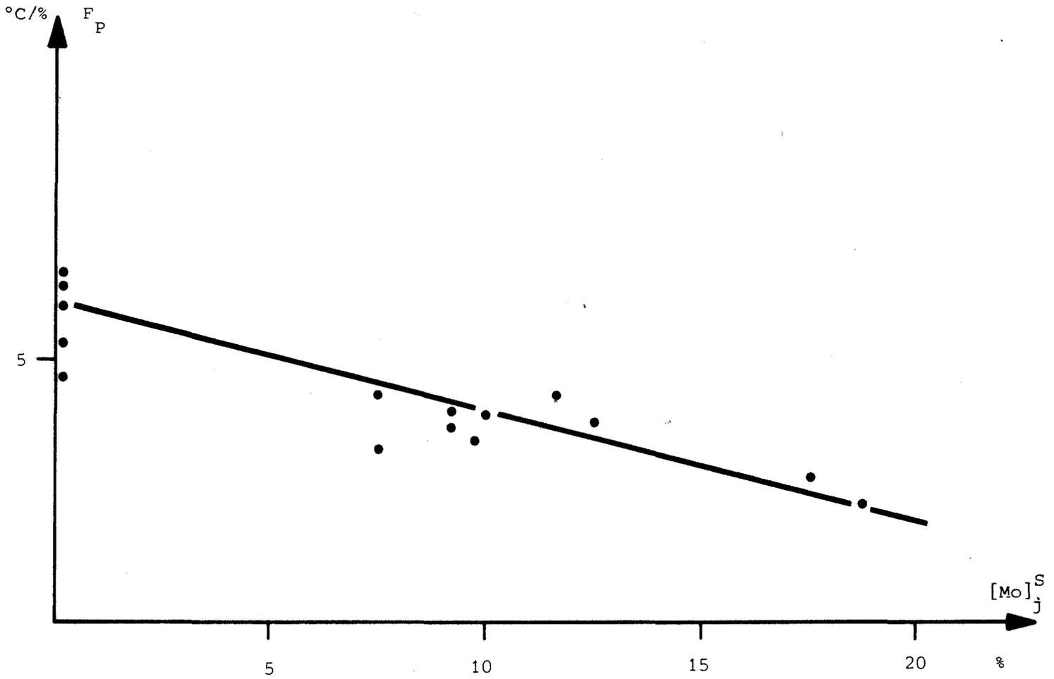
FIG.86 : Evolution du pouvoir fragilisant  $F_p$  en fonction de la concentration intergranulaire en Mo.
