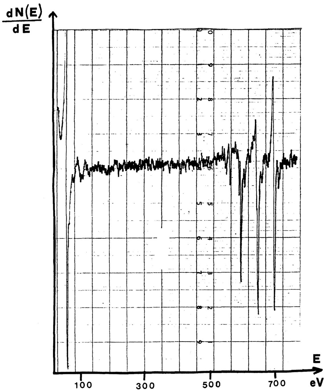
FIG.60 : Spectre AUGER dérivé du fer de haute pureté - Analyse d'une surface de rupture par clivage.
