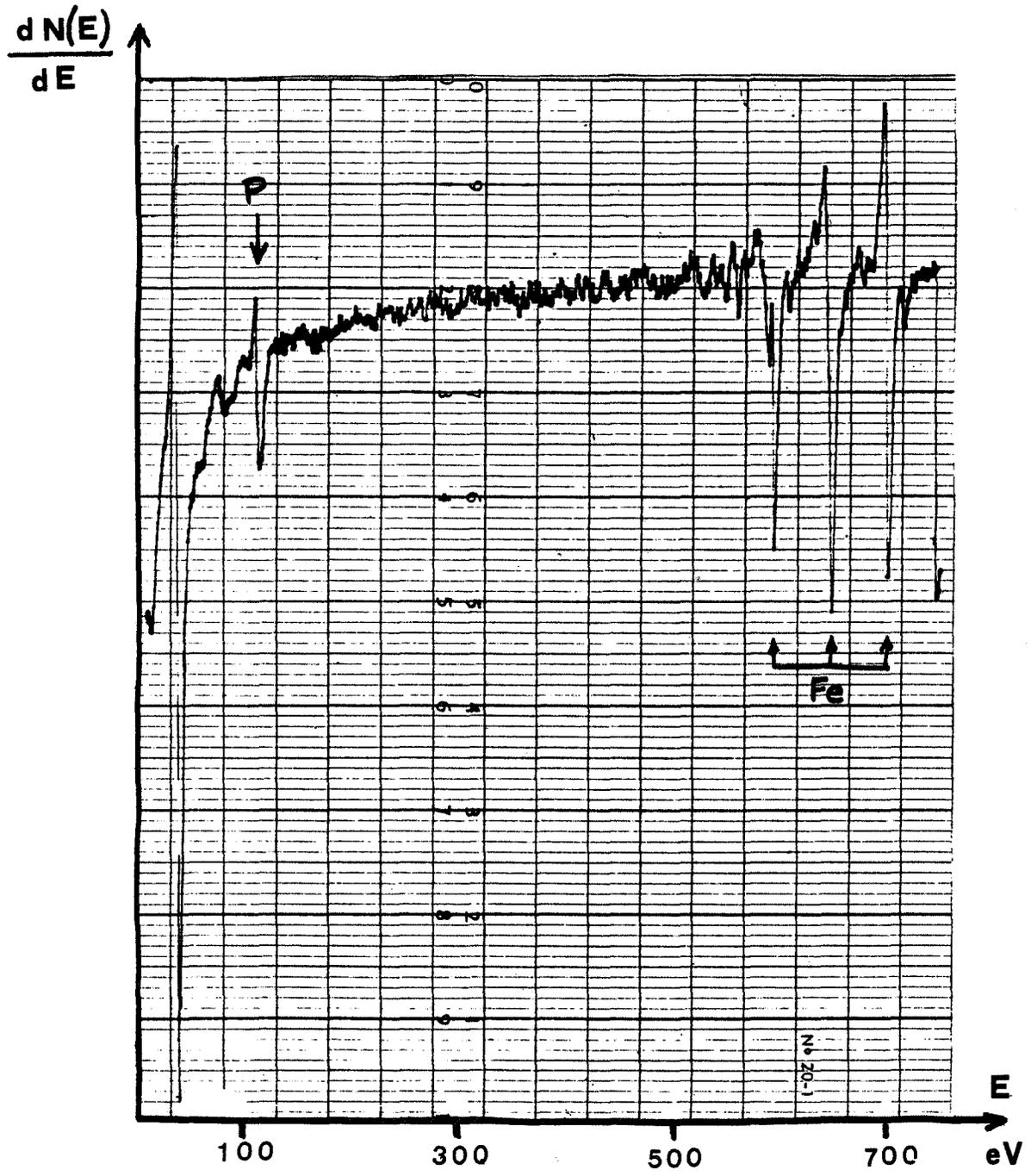
FIG.69 : Spectre AUGER dérivé - coulée 4 (P : 360ppm - Mo : 0%)
