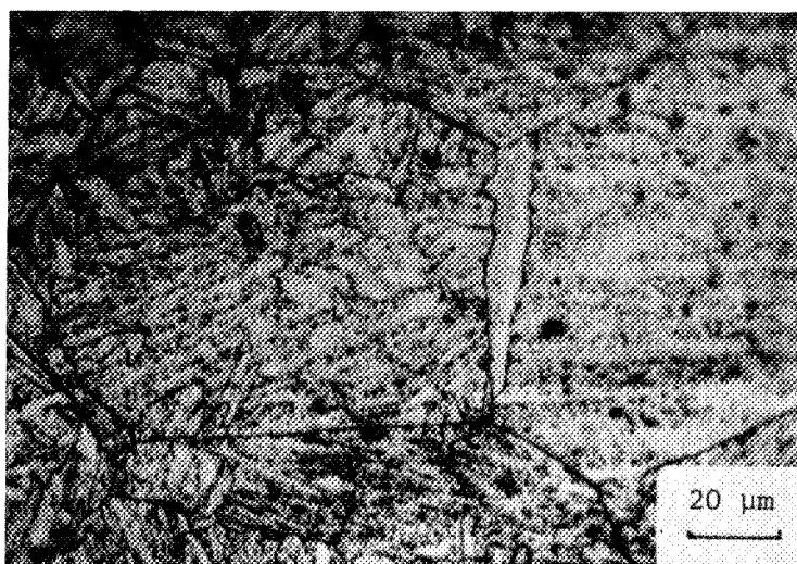
FIG.39 : Germination de lattes de martensite dans un ancien joint de grains d'austénite (acier contenant Mo:0%, P : 400ppm; état F 1 ).
