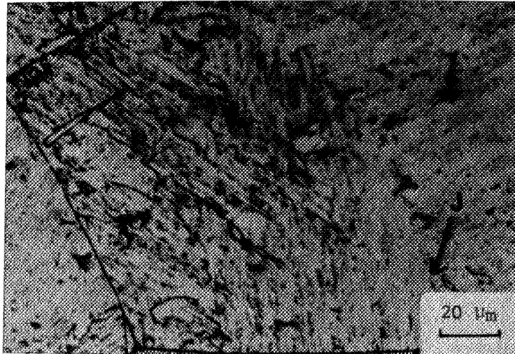
FIG.43 : Ségrégation dans les joints d'un noeud triple de l'ancien réseau de l'austénite (attaque acide picrique + teepol).
