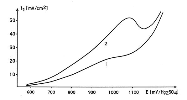
Fig. II.7. Etude préliminaire - courbes intensité-potentiel dans l'acide sulfurique 2N, T = 50°C, vitesse de balayage en potentiel - 4V/h ( $1 - N^31$ ,  $2 - N^32$ )
