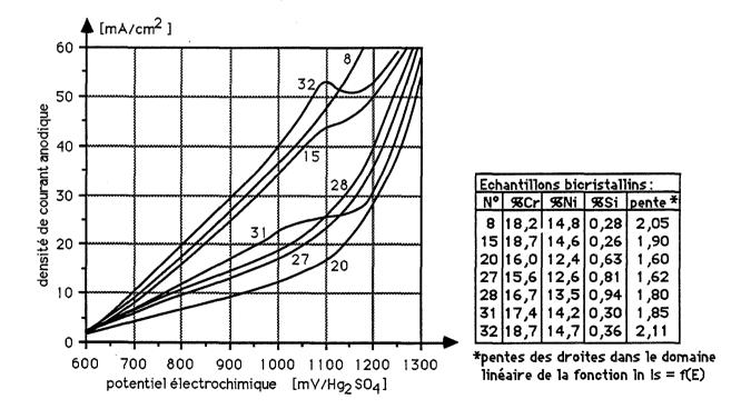
Fig. III.11. Courbes potentiostatiques de polarisation des échantillons bicristallins dans  $H_2SO_4/2N$
