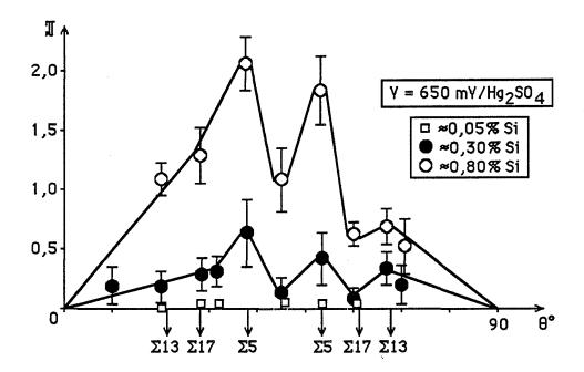
Fig. VI.14. Relation entre l'angle de désorientation et l'intensité de la corrosion intergranulaire transpassive dans les bicristaux symétriques de flexion autour de <001> de l'acier inoxydable 17-13 contenant du silicium - test potentiostatique dans l'acide sulfurique 2N à 650 mV/Hg<sub>2</sub>SO<sub>4</sub>
