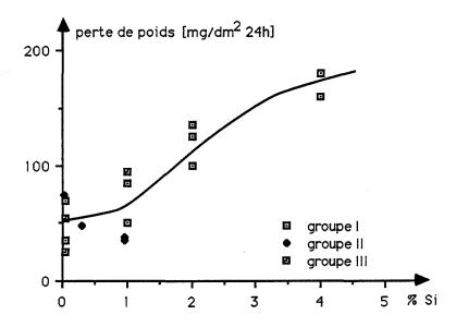
Fig. III.5. Relation entre la vitesse de dissolution générale lors du test Huey et la teneur en Si de l'acier dans l'état hypertrempé
