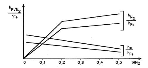
Fig. I.39. Variation de l'enrichissement des joints de grains en phosphore et en azote en fonction de la teneur en  $N_2$ , dans les alliages Fe-P- $N_2$  à 600°C (d'après Erhart et Grabke, 1981)
