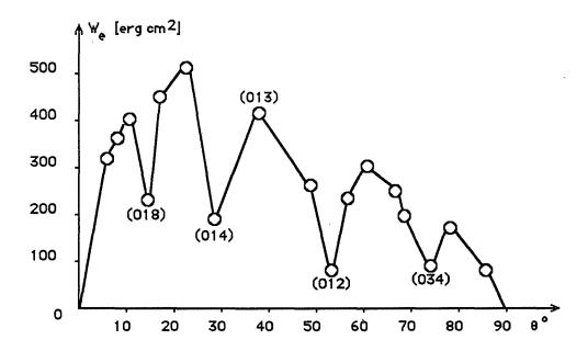
Fig. I.13. Energie de joints de grains de flexion symétriques d'axe <100> dans l'aluminium, calculée en tenant compte de la nature discontinue des deux cristaux (Baroux et Biscondi,1970)
