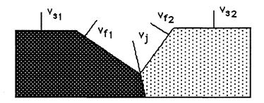
Fig. V.1. Schéma d'un sillon d'attaque intergranulaire - cas général
