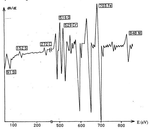
Fig. II.11. Exemple du spectre Auger enregistré sur la face de rupture intergranulaire de l'acier 17-13-03Si hypertrempé
