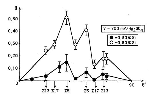
Fig. VI.15. Relation entre l'angle de désorientation et l'intensité de la corrosion intergranulaire transpassive dans les bicristaux symétriques de flexion autour de <001> de l'acier inoxydable 17-13 contenant du silicium - test potentiostatique dans l'acide sulfurique 2N à 650 mV/Hg<sub>2</sub>SO<sub>4</sub>
