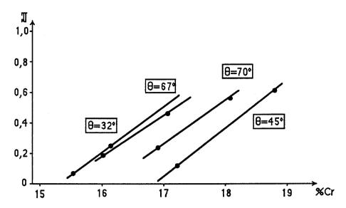
Fig. VI.9. Relation entre la teneur en chrome et l'intensité de l'attaque intergranulaire dans les bicristaux de flexion <001> de l'acier inoxydable 17Cr-13Ni
