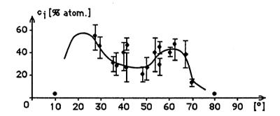
Fig. I.19. Concentration intergranulaire du bismuth en fonction de l'angle de désorientation des joints de flexion symétriques autour de <100> dans le cuivre, après un traitement de 24h à 500°C (Fraczkiewicz et Biscondi,1985)
