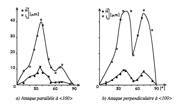
Fig. I.25. Influence de la désorientation sur la hauteur et la largeur des sillons après attaque potentiostatique des joints de flexion symétriques autour de <100> de l'acier inoxydable dans l'acide sulfurique (Beaunier et Froment,1974)
