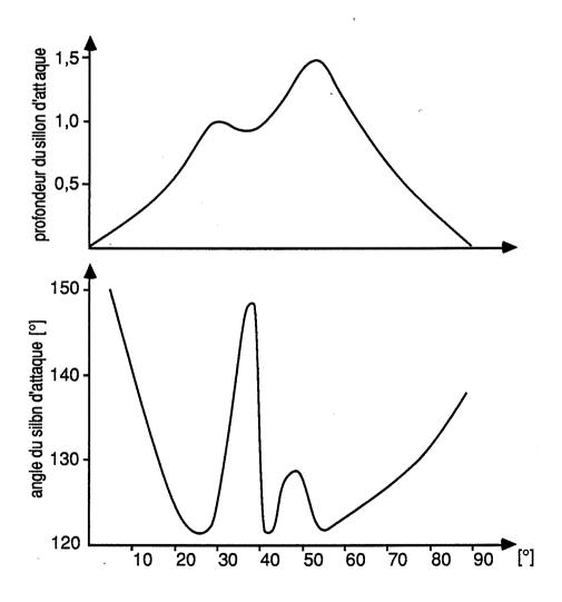
Fig. I.23. Influence de la désorientation sur l'angle d'ouverture et la profondeur des sillons apparus après attaque des joints de flexion symétriques autour de <100> de l'aluminium dans l'acide chlorhydrique (d'après Froment et Vignaud,1971)
