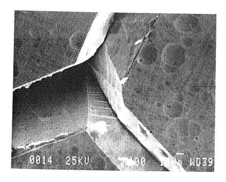
(d) Alliage 100P-1Si, attaque dans  $H_2SO_4/2N$  à 650 mV/ $Hg_2SO_4$
