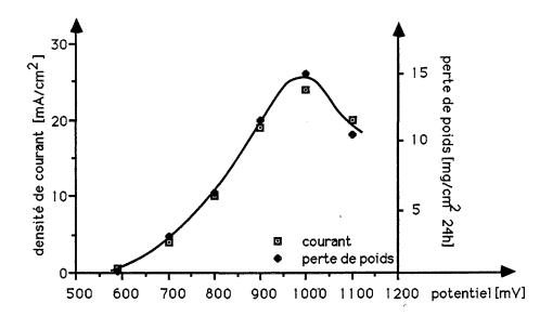
Fig.III.7. Densité de courant anodique et perte de poids au cours de tests potentiostatiques de corrosion dans H<sub>2</sub>SO<sub>4</sub>/2N - acier U16-1Si hypertrempé
