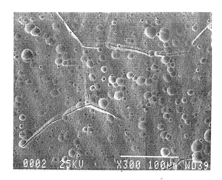
Fig. VI.7. Acier 17-13-0Si, 24h 1200°C/eau, test potentiostatique dans  $H_2SO_4/2N$ , T=50°C, 650 mV/ $Hg_2SO_4$
