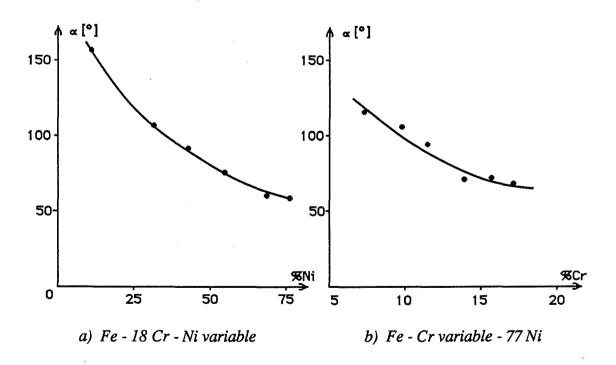
Fig. I.28. Evolution de l'angle d'ouverture du sillon d'attaque intergranulaire (d'après Beaunier, 1976 et 1979)
