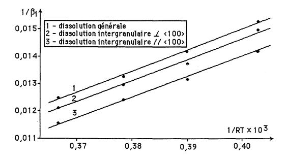
Fig. V.5. Variation de la constante de Tafel en fonction de la température pour les processus de dissolution générale et intergranulaire dans le bicristal <001>53° de nickel
