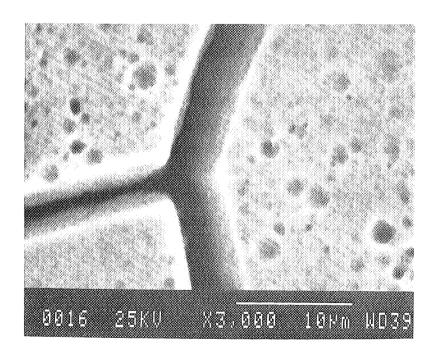
Fig. VI.8 b et c. Acier 17-13-0Si, 24h 1200°C/eau, test Huey - 1 période de 48 heures
