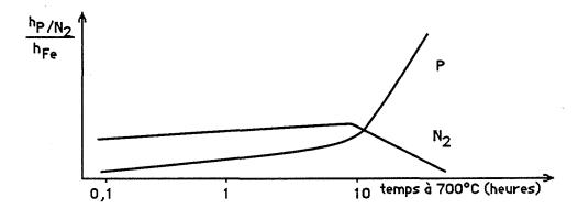
Fig. I.38. Ségrégation intergranulaire du phosphore te de l'azote à 700°C dans l'acier 316L (d'après Mulford et coll., 1983)
