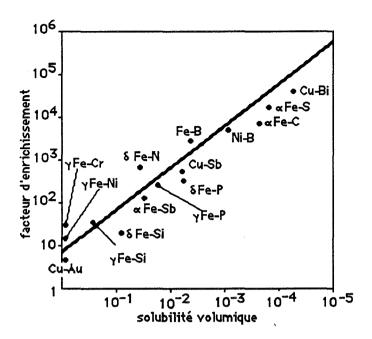
Fig. I.9. Relation entre le facteur d'enrichissement du joint  $\beta$  et la solubilité volumique de l'élément ségrégeant  $c_v^o$  (d'après Hondros, 1975)
