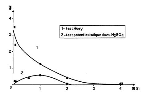
Fig. VI.5. Intensité de l'attaque intergranulaire transpassive des aciers de pureté industrielle (groupe I) hypertrempés (1h - 1200°C/eau), testés dans H<sub>2</sub>SO<sub>4</sub> (potentiel imposé dans le domaine transpassif) et dans HNO<sub>3</sub> (potentiel libre)
