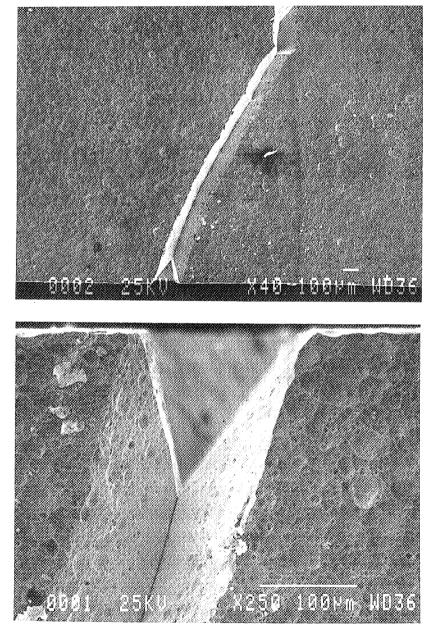
(b) Bicristal N°30 - attaque dans  $H_2SO_4/2N$  à 600 mV/ $Hg_2SO_4$
