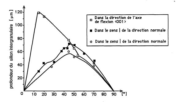
Fig. I.22. Variation de la profondeur du sillon intergranulaire avec l'angle de désorientation des deux grains autour de <100> dans l'aluminium (Boos et Goux,1970)
