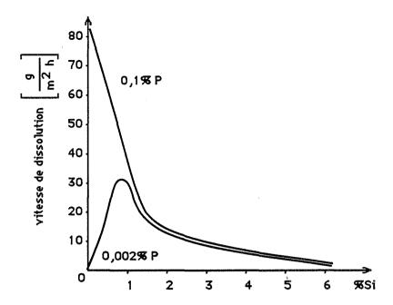
Fig. I.35. Influence de la teneur en silicium dans l'acier Fe-20Cr-20Ni contenant 0,002 et 0,1%P sur la vitesse de corrosion dans la solution 5N HNO3 + 40g/l CrVI à ébullition (d'après Kolotyrkin et coll.,1984)
