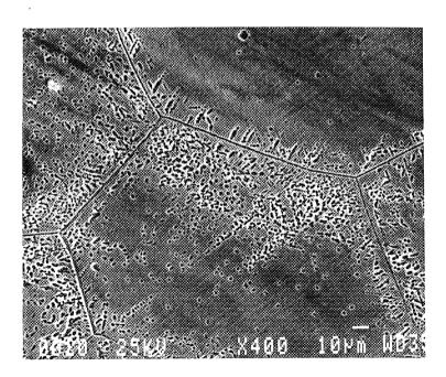
Fig. IV.10. Inversion de l'attaque par piqûres dans l'acier U16-06Si soumis à un maintien de une heure à 700°C après l'hypertrempe - test potentiostatique dans  $H_2SO_4/2N$
