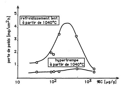
Fig. I.31. Influence de la teneur en carbone sur la résistance à la corrosion dans une solution HNO<sub>3</sub>/Cr<sup>6+</sup> d'aciers Fe-14Cr-14Ni de très haute pureté, hypertrempés ou sensibilisés d'après Armijo,1968)
