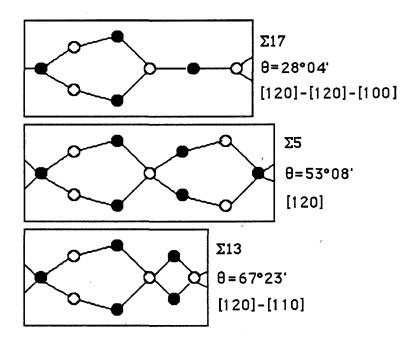
Fig. VI.17. Structure des joints de grains symétriques de flexion autour de <001> dans les métaux purs de structure c.f.c. - schéma d'après Hasson (1972)
