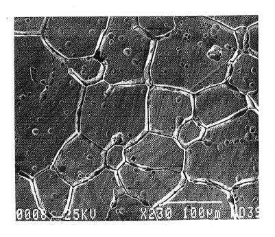
Fig. IV.2. Surface de l'acier 17-13-1Si attaqué dans  $H_2SO_4/2N$  après un maintien de **24 heures** à **1200** °C ( $Q_S = 40$  C/cm², V = 600 mV, T = 50 °C)
