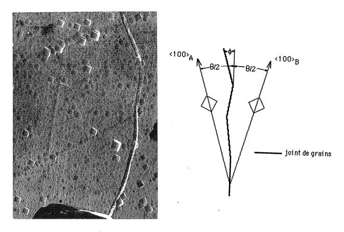
Fig. IV.12. Figures de corrosion dans le bicristal 17-13-03Si <100>37°30' (N°31) - attaque dans  $H_2SO_4/2N$  à 650 mV/Hg<sub>2</sub>SO<sub>4</sub>
