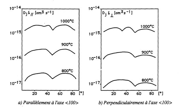
Fig. I.16. Autodiffusion intergranulaire du fer dans les bicristaux de flexion autour de <100> de l'acier inoxydable Fe-16Cr-14Ni - influence de la désorientation et de la température (d'après Assasa et coll.,1975)
