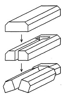
Fig. II.1. Préparation, à partir d'un monocristal, de germes bicristallins de flexion autour de l'axe <001>
