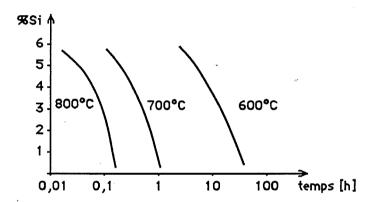
Fig. I.29. Précipitation des carbures dans les aciers du type Fe-18Cr-15Ni au silicium (Horn et Kügler,1977)
