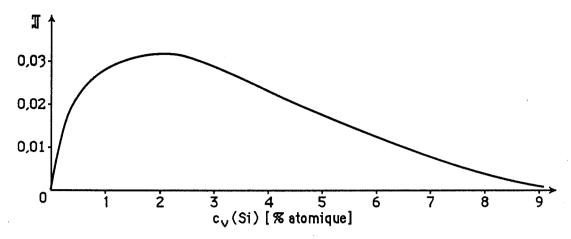
Fig. V.7. Relation entre l'intensité de l'attaque intergranulaire et la teneur volumique en silicium dans un acier inoxydable austénitique - prévision théorique
