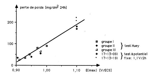
Fig. III.6. Relation entre le potentiel maximal enregistré lors de tests dans l'acide nitrique 14,4N et la vitesse de dissolution générale des aciers hypertrempés contenant entre 0 et 1% Si
