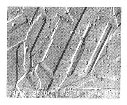
Fig.VI.3. Acier 17-13-03Si, 1h 1200 °C/eau, test potentiostatique  $H_2SO_4/2N$ , 50 °C, 650 mV/ $H_{82}SO_4$
