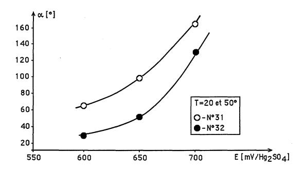
Fig. II.9. Influence du potentiel électrochimique sur l'angle d'ouverture des sillons d'attaque intergranulaire
