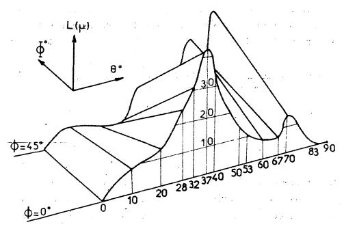
Fig. I.27. Relation entre l'asymétrie des joints et la largeur des sillons dans les bicristaux de flexion autour de <100> de l'acier inoxydable Fe-17Cr-13Ni (Beaunier,1979)
