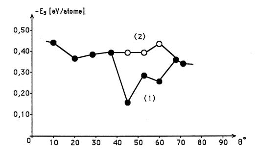
Fig. VI.20. Energie de ségrégation du silicium dans les bicristaux de flexion <001> d'acier inoxydable calculée à partir des résultats du test potentiostatique de corrosion intergranulaire en utilisant les concentrations limites en silicium au joint selon Tableau VI.7.
