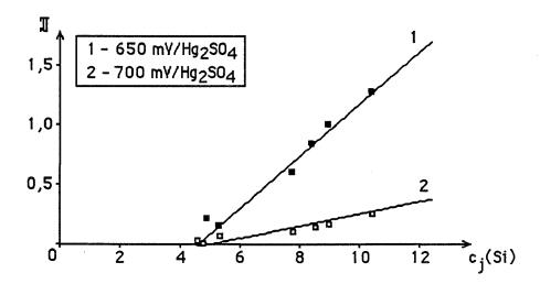
Fig. VI.12. Relation entre l'intensité de la corrosion transpassive et la ségrégation intergranulaire du silicium (potentiel mesuré par rapport à l'électrode au sulfate mercureux)
