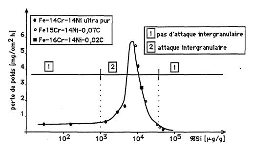
Fig. I.33. Influence de la teneur en silicium sur la résistance à la corrosion dans une solution  $HNO_3/Cr^{6+}$  des aciers Fe-14Cr-14Ni de très haute pureté (d'après Armijo, 1968)
