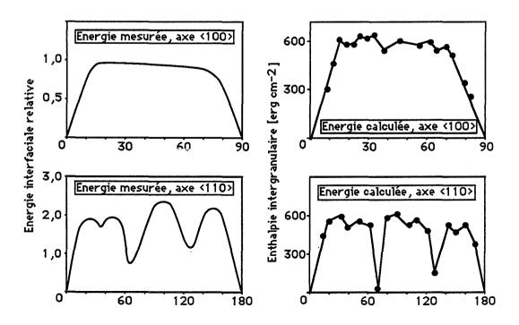
Fig. I.12. Variation de l'énergie des joints de grains de flexion dans l'aluminium, en fonction de l'angle de désorientation (d'après Hasson et Goux, 1971)
