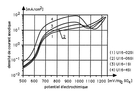
Fig. III.8. Courbes potentiostatiques de polarisation des aciers du groupe I (Tableau II.1) dans H<sub>2</sub>SO<sub>4</sub> /2N
