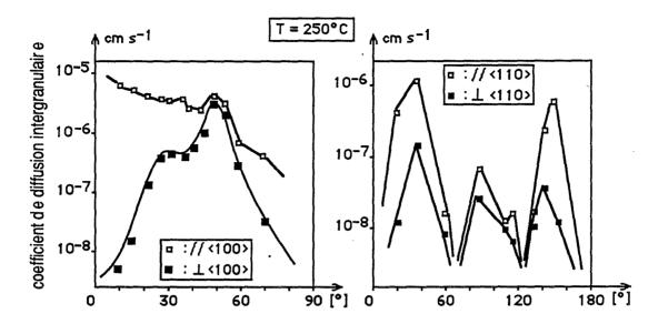
Fig. I.15. Variation du coefficient de la diffusion intergranulaire du zinc dans les joints symétriques de flexion autour de <100> et <110> de l'aluminium à 250°C - influence de l'angle de désorientation et de la direction de la diffusion (d'après Biscondi,1984)
