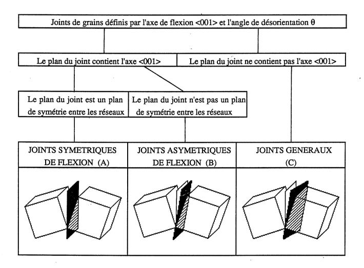
L'angle de désorientation  $\theta$  suffit pour définir les joints du groupe A. Dans le groupe B, il est nécessaire d'introduire le paramètre d'asymétrie  $\phi$ , défini comme l'angle dièdre entre le plan du joint et le plan de symétrie entre les deux réseaux. Nous prendrons également en compte la valeur du paramètre d, défini de la manière suivante (Bouchet et Priester, 1986):
