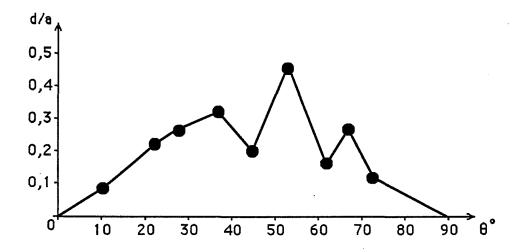
Fig. VI.21. Influence de l'angle de désorientation dans les bicristaux symétriques de flexion autour de <001> sur la distance interplanaire du plan du joint:  $d/a = (h^2 + k^2 + l^2)^{-1/2}$
