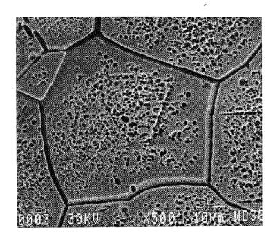
Fig. IV.5. Piqûres dans l'acier U16-06Si hypertrempé (1h 1200°C/eau) attaqué dans  $H_2SO_4/2N$ , après passage de 10 C/cm<sup>2</sup> (V = 600 mV, T = 50°C)
