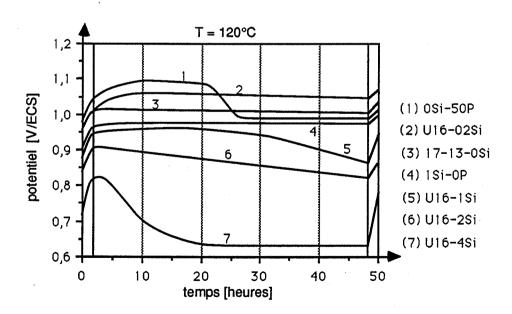
Fig. III.2. Evolution du potentiel électrochimique des échantillons d'aciers inoxydables hypertrempés en fonction de la durée de maintien dans HNO<sub>3</sub>/14,4N à ébullition
