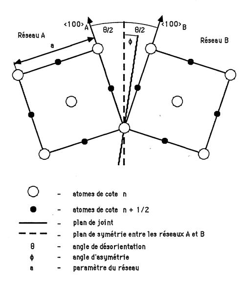
Fig. II.3. Structure d'un bicristal de flexion autour de <001>, d'un métal cubique à faces centrées. Coupe perpendiculaire à l'axe de flexion
