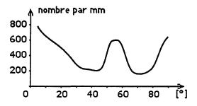
Fig. I.17. Densité linéaire de précipités, en fonction de l'angle de désorientation de bicristaux Al-4Cu de flexion symétriques d'axe <100> (Le Coze et coll.,1973)
