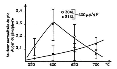
Fig. I.37. Ségrégation intergranulaire du phosphore dans les aciers 304L et 316L après des traitements de 100h à des températures entre 550 et 700°C (d'après Briant, 1987)
