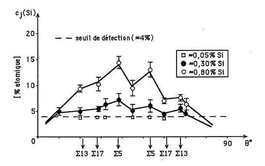
Fig.VI.16. Relation entre l'angle de désorientation et le niveau de ségrégation intergranulaire du silicium dans les bicristaux symétriques de flexion autour de <001> de l'acier inoxydable 17-13 (calcul à partir des résultats des tests potentiostatiques de corrosion intergranulaire)
