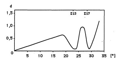
Fig. I.20. Variation de la profondeur de l'attaque intergranulaire dans des bicristaux de flexion autour de <100> dans le niobium (d'après Qian et Chou,1984)
