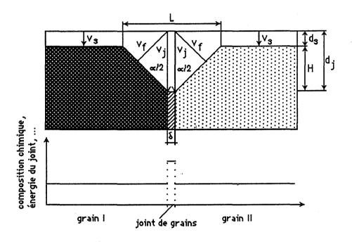
Fig. V.2. Géométrie du sillon d'attaque intergranulaire - schéma simplifié
