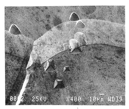
Fig. IV.11. Variation de la forme géométrique des piqûres en fonction de l'orientation cristallographique - alliage 100P-0Si, test dans H<sub>2</sub>SO<sub>4</sub>/2N à 650 mV/Hg<sub>2</sub>SO<sub>4</sub>
