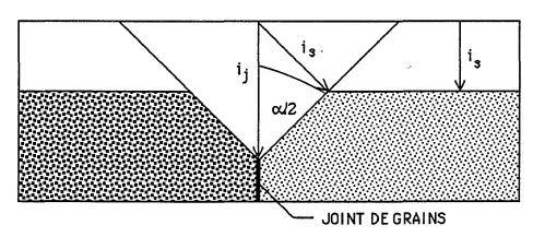
Fig. I.8. Mécanisme de dissolution des joints de grains (d'après Beaunier, 1979)
