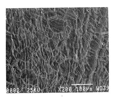
Fig. IV.1. Ondulations dans l'acier 17-13-1Si hypertrempé (1h 1200°C/eau) après passage de 20 C/cm<sup>2</sup>, dans  $H_2SO_4/2N$  (V=600 mV/ $H_82SO_4$ , T=50°C)
