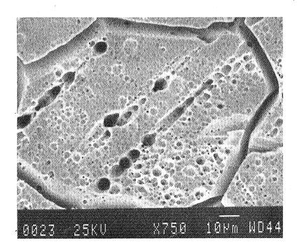
Fig. VI.6. Attaque des joints de macles dans l'acier U16-01Si hypetrempé (1h 1200°C/eau, test Huey,1 période de 48 heures)
