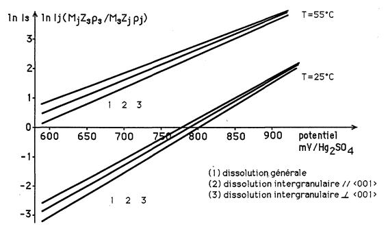
Fig.V.4. Courbes de polarisation de dissolution générale et intergranulaire du bicristal de nickel <001>53° dans l'acide sulfurique 2N
