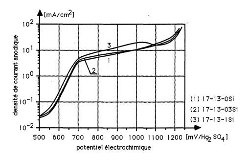
Fig. III.9. Courbes potentiostatiques de polarisation des aciers du groupe II (Tableau II.1) dans H<sub>2</sub>SO<sub>4</sub> /2N
