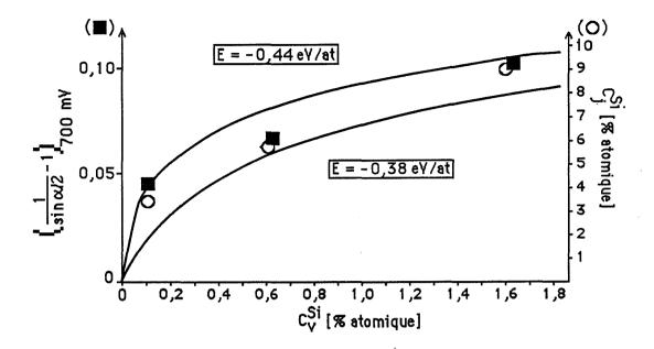
Fig. V.6. Evolution de la concentration du silicium au joint <001>20° de l'acier inoxydable Fe-17Cr-13Ni et de l'intensité de la corrosion intergranulaire en fonction de la teneur volumique en Si (traitement thermique - 24 h 600°C/eau)
