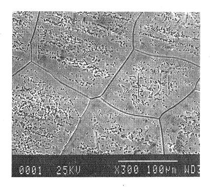
Fig. IV.8. Attaque par piqûres dans l'acier U16 hypertrempé (1h 1200°C/eau) testé dans HNO $_3$  14,4N à ébullition (2 périodes de 48 heures)
