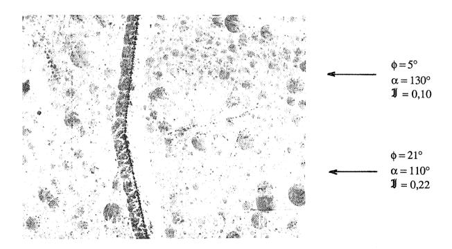
Fig. VI.22. Corrosion intergranulaire du bicristal N°33 ( $<001>60^{\circ}$ ) dans l'acide sulfurique 2N à  $650 \text{ mV/Hg}_2\text{SO}_4$
