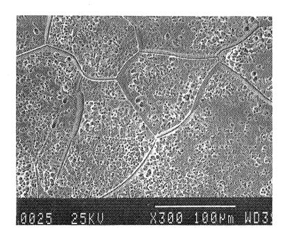
Fig. IV.9. Attaque par piqûres de l'acier U16-2Si après le test Huey (1 période de 48 heures)
