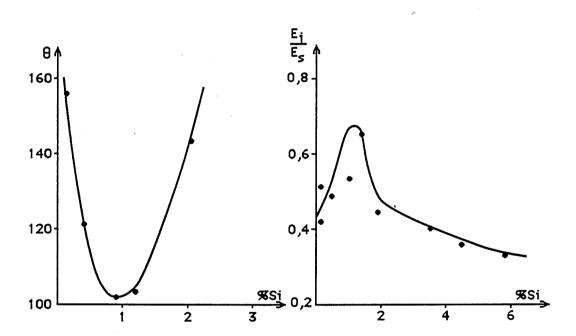
Fig. I.34. a) Attaque électrolytique de l'acier Fe-14Cr-14Ni dans l'acide sulfurique 2N à 1,1 V/ECS - évolution de l'angle du sillon intergranulaire en fonction de la teneur en silicium
