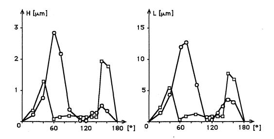
Fig. I.24. Influence de la désorientation sur la hauteur et la largeur des sillons après attaque des joints de flexion symétriques autour de <110> de l'aluminium dans l'acide chlorhydrique (d'après Froment et Vignaud,1971)
