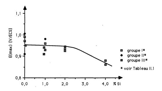
Fig. III.3. Variation de la valeur maximale du potentiel électrochimique lors du test Huey en fonction de la teneur en silicium de l'acier dans l'état hypertrempé
