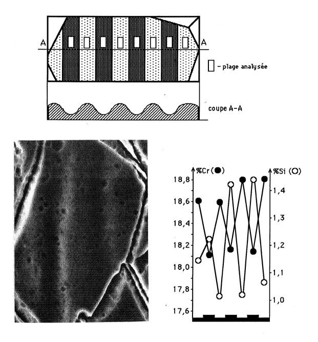
Fig. IV.3. Mode opératoire et exemple d'analyse de la composition chimique dans les ondulations. Acier 17-13-1Si hypertrempé après un maintien de une heure à 1200°C
