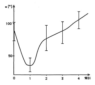
Fig. I.36. Influence de la teneur en silicium sur l'angle d'ouverture des sillons intergranulaires dans les conditions potentiostatiques,  $Q = 20 \text{ C/cm}^2$  (Beaunier et Froment, 1974)
