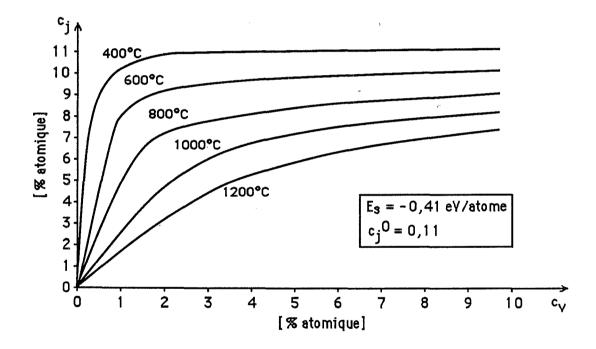
Fig. VI.11. Influence de la température sur la ségrégation intergranulaire du silicium dans l'acier inoxydable - estimation à partir du modèle de McLean
