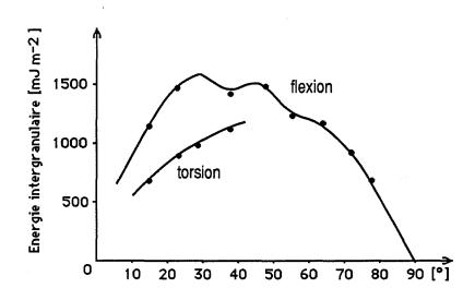
Fig. I.14. Energie calculée de joints de grains de flexion et de torsion symétriques d'axe <100> dans le cuivre (d'après Sutton et Vitek,1983)
