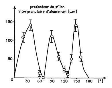
Fig. I.21. Variation de la profondeur du sillon intergranulaire avec l'angle de désorientation des deux grains autour de <110> dans l'aluminium (Boos et Goux,1970)
