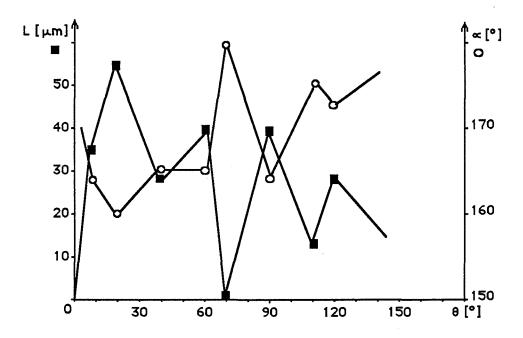
Fig. I.26. Influence de la désorientation sur les paramètres des sillons après attaque des joints de flexion symétriques autour de <110> de l'acier inoxydable Fe-17Cr-13Ni dans l'acide sulfurique - attaque parallèle à <110> (Béaunier et Froment,1974)
