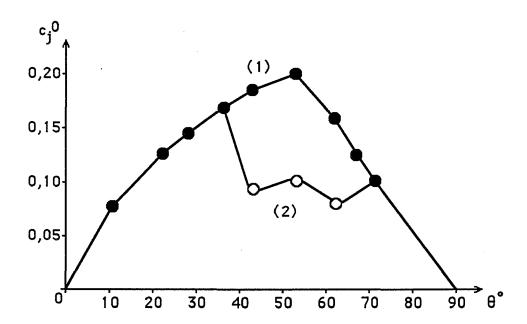
Fig. VI.19. Concentration limite en silicium aux joints de grains de flexion <001>- prévision théorique
