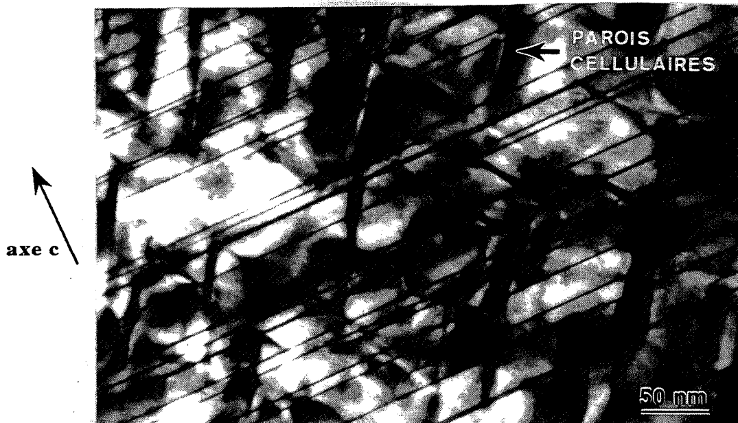
figure I.16: Microstructure cellulaire d'un aimant permanent de type \text{Sm}(\text{CoFeCuZr})_{7-9} observée en M.E.T. (Klo93)
