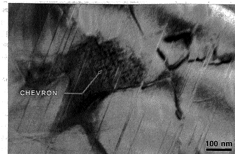
figure V.4: Contraste des chevrons en axe de zone [11\bar{2}0]
