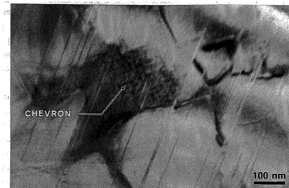
figure V.4: Contraste des chevrons en axe de zone  $[11\bar{2}0]$
