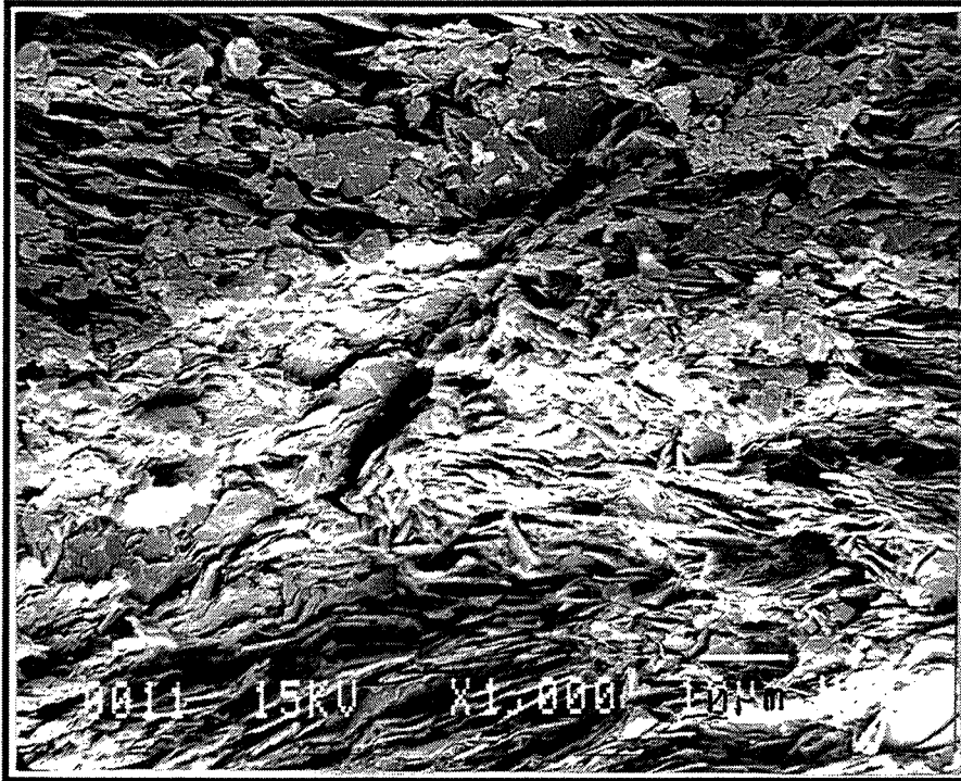
fig. B18: Faciès de rupture de FRIT5 Mauvaise orientation des plaquettes de BN
