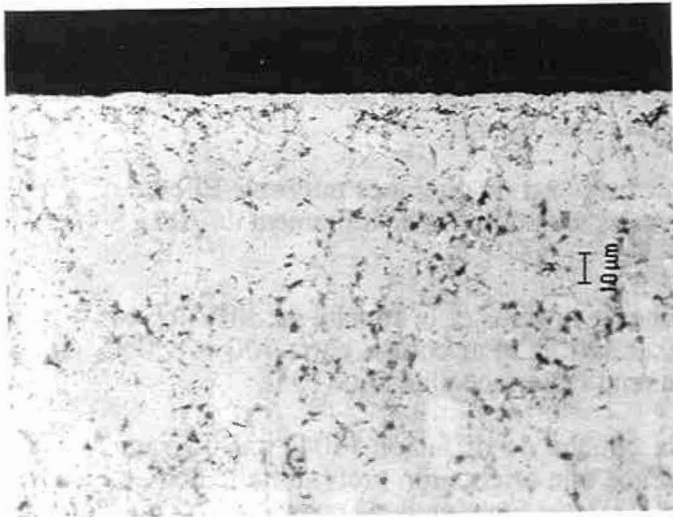
b) TA6V nitruré à 740°C. Couche de nitrures visible, couche de diffusion sans phase \beta . Les grains de la matrice ont un aspect moins allongé.
