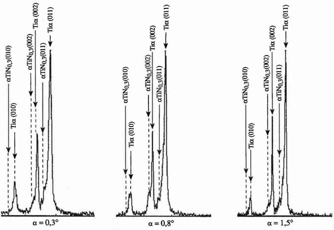
Figure 86 - Spectres de diffraction des rayons X en incidence rasante d'une surface en TA6V implanté  $3.10^{17}$  N+/cm². Domaine angulaire de  $2\theta = 33^{\circ}$  à  $2\theta = 46^{\circ}$ ;  $\lambda K\alpha Cu = 1,5418$  Å; incidences  $\alpha = 0,3^{\circ}$ ,  $\alpha = 0,8^{\circ}$ ,  $\alpha = 1,5^{\circ}$
