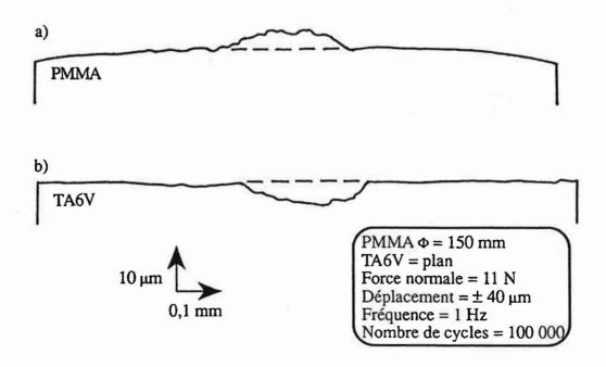
Figure 44 - Profils de rugosité après fretting en solution de Ringer a) surface du cylindre (PMMA)
