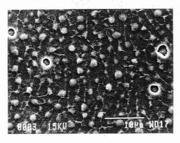
c) TA6V implanté 1,5.10<sup>18</sup> N<sup>+</sup>/cm<sup>2</sup>. Apparition de bulles d'azote situées principalement aux joints de grains. quelques bulles semblent avoir éclaté
