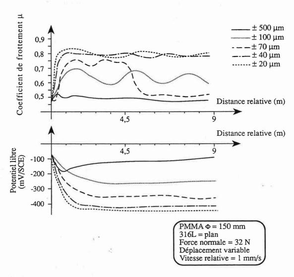
Figure 69 - Evolution du coefficient de frottement  $\mu$  et du potentiel de corrosion E en fonction du nombre de cycles. Transition entre frottement de grande amplitude et fretting pour un contact cylindre (PMMA) sur plan (316L) . Solution de Ringer.
