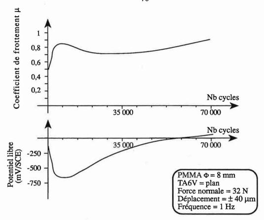
Figure 37 - Evolution du coefficient de frottement  $\mu$  et du potentiel de corrosion E en fonction du nombre de cycles. Contact cylindre (PMMA) sur plan (TA6V) . Solution de Ringer. Pression maximale de Hertz de 25 MPa
