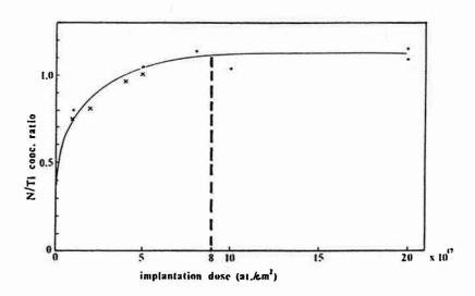
Figure 71 - Rapport de concentration N/Ti, en fonction de la dose implantée, obtenu par RBS. Implantations de  $N^+$  et de  $N_2^+$  à 80 keV. (91)
