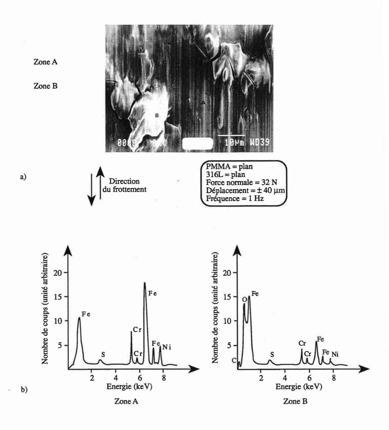
Figure 68 - Mise en évidence par micro-analyse X dispersive en énergie du détachement de particules riches en oxygène dans la zone de frottement du 316L.
