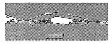
Ejection moyenne : les débris s'accumulent à la périphérie du contact et sont à l'origine des fissures
