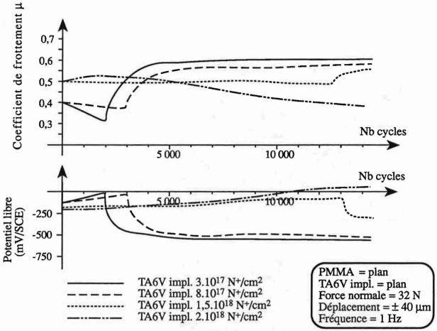
Figure 75 - Evolution du coefficient de frottement μ et du potentiel de corrosion E en fonction du nombre de cycles après implantation ionique d'azote à 3.10<sup>17</sup>, 8.10<sup>17</sup>, 1,5.10<sup>18</sup> et 2.10<sup>18</sup> N+/cm<sup>2</sup>. Contact plan (PMMA) sur plan (TA6V impl.). Solution de Ringer.
