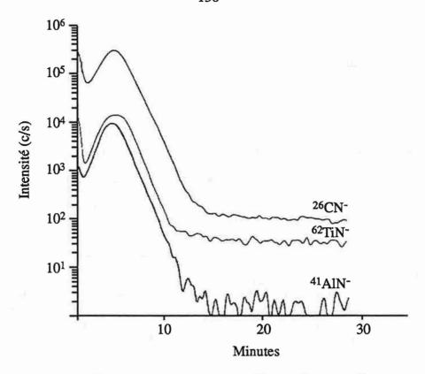
Figure 92 - Profils des ions  $^{26}\text{CN}^-$ ,  $^{41}\text{AlN}^-$  et  $^{62}\text{TiN}^-$  sur un échantillon en TA6V implanté  $8.10^{17}~\text{N}^+/\text{cm}^2$ . (source Ar+, mode négatif, intensité du faisceau d'ions primaires  $i_p = 420~\text{nA}$ , diamètre du champ analysé  $I_f = 150~\mu\text{m}$ )
