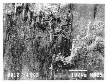
b) Limite inférieure de la zone en relief. Transition avec le reste de la plage de frottement
