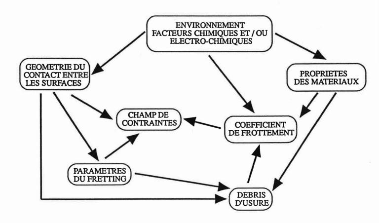
Figure 11 - Corrélation entre les principaux facteurs de l'usure par fretting-corrosion
