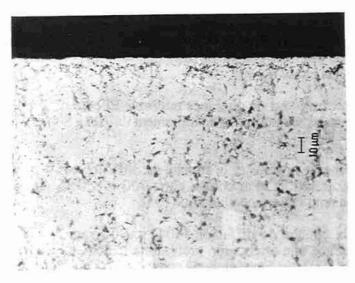
b) TA6V nitruré à 740°C. Couche de nitrures visible, couche de diffusion sans phase β. Les grains de la matrice ont un aspect moins allongé.
