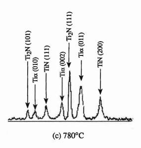
Figure 104 - Spectres de diffraction des rayons X des surfaces en TA6V nitruré : (a)  $620^{\circ}$ C; (b)  $740^{\circ}$ C; (c)  $780^{\circ}$ C. Domaine angulaire de  $2\theta = 38^{\circ}$  à  $2\theta = 54^{\circ}$ ;  $\lambda K\alpha Co = 1,7893$  Å;
