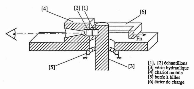
Figure 13 - Dispositif de fretting de l'Ecole Centrale
