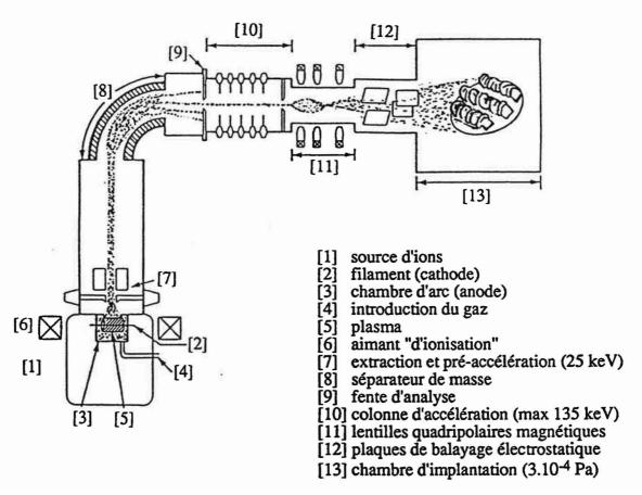
Figure 17 - Représentation schématique de l'implanteur industriel 200-1000 Varian de la société NITRUVID
