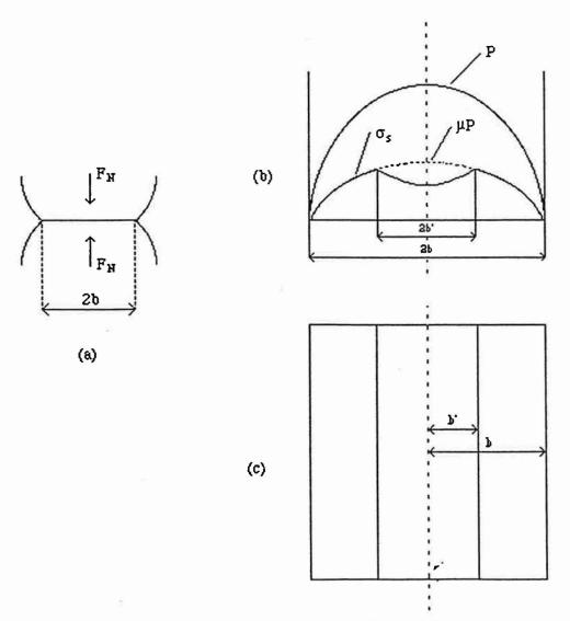
Figure 4 - Pression de Hertz et contraintes de cisaillement dans un contact entre deux cylindres élastiques d'après (10). (a) Largeur du contact = 2b; (b) Distribution de pression de Hertz et contraintes de cisaillement (glissement partiel); (c) Vue en plan du contact entre deux cylindres : Zone centrale d'adhérence de largeur l = b' - Zone périphérique de glissement pour b' < l < b.
