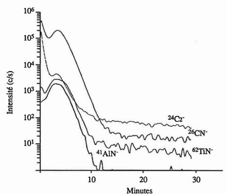
Minutes Figure 96 - Profils des ions  $^{24}\text{C}_2^-$ ,  $^{26}\text{CN}^-$ ,  $^{41}\text{AlN}^-$  et  $^{62}\text{TiN}^-$  sur un échantillon en TA6V implanté 1,5.1018 N+/cm². (source Ar+, mode négatif, intensité du faisceau d'ions primaires  $i_p$  = 420 nA, diamètre du champ analysé  $I_f$  = 150  $\mu$ m)
