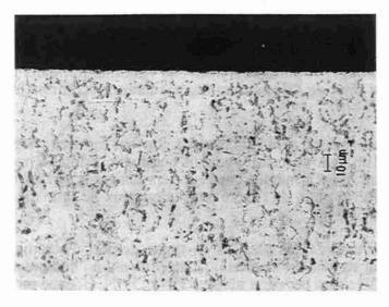
c) TA6V nitruré à 780°C. Couche de nitrures plus épaisse, couche de diffusion et matrice semblables au cliché précédent.
