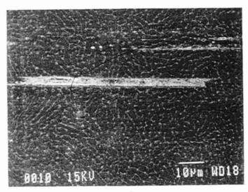
b) TA6V implanté 1,5.10<sup>18</sup> N+/cm<sup>2</sup> Aspect de la surface à 100 000 cycles. Rayures superficielles et locales des surfaces. Mise en évidence de bulles d'azote.
