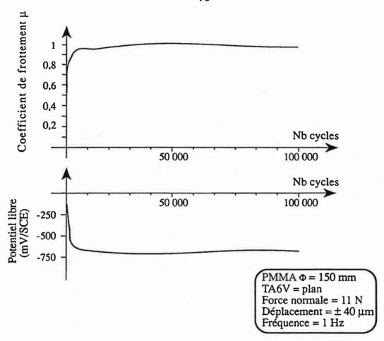
Figure 43 - Evolution du coefficient de frottement  $\mu$  et du potentiel de corrosion E en fonction du nombre de cycles. Contact cylindre (PMMA) sur plan (TA6V) . Solution de Ringer. Pression maximale de Hertz de 3 MPa
