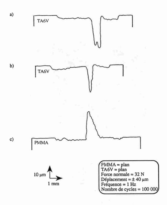
Figure 56 - Profils de rugosité après fretting en solution de Ringer a) surface du plan au milieu du contact (TA6V)
