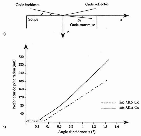
Figure 24 - Diffraction des RX sous incidence rasante
