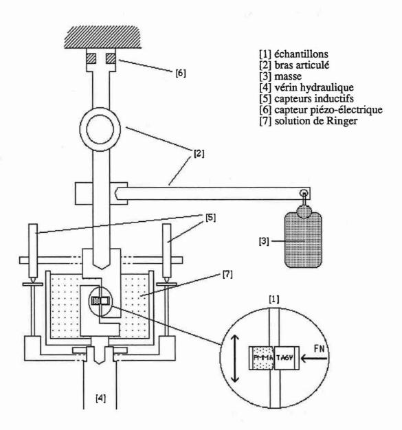
Figure 14 - Dispositif de fretting de l'Ecole des Mines
