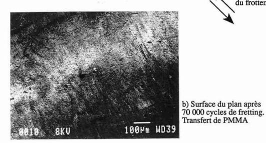
Figure 42 - Surfaces du TA6V après fretting en solution de Ringer. Pression maximale de Hertz égale à 25 MPa
