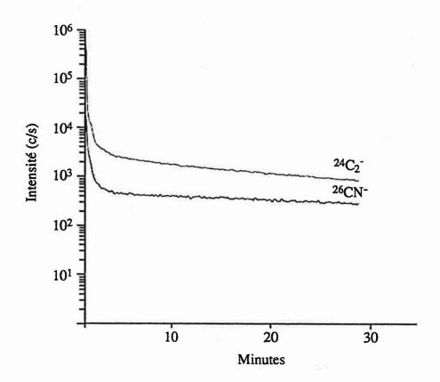
Figure 91 - Profils des ions  $^{24}C_2^-$  et  $^{26}CN^-$  sur un échantillon en TA6V non traité. (source Ar+, mode négatif, intensité du faisceau d'ions primaires  $i_p$  = 430 nA, diamètre du champ analysé  $I_f$  = 150  $\mu$ m)
