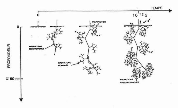
Figure 16 - Représentation schématique du développement dans le temps de la cascade de collisions induites par la pénétration d'un ion dans la matière
