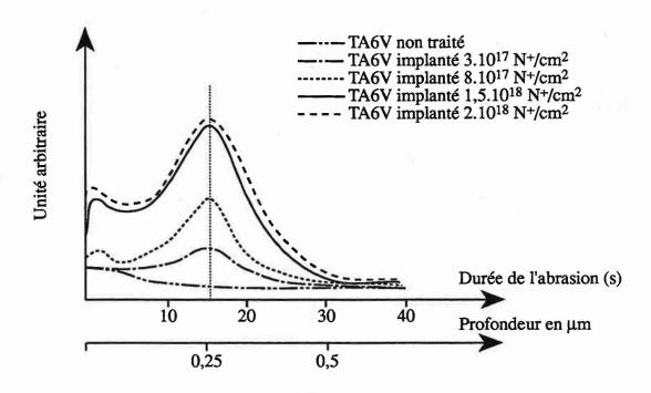
Figure 78 - Spectres SDL de la répartition en profondeur de l'azote implanté à 120 keV dans du TA6V pour les différentes doses étudiées.
