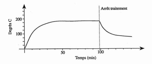
Figure 74 - Evolution de la température du TA6V pendant l'implantation d'ions N+ à 120 keV et 5 μA/cm2. La température est mesurée à l'aide d'un thermocouple placé à 1mm de la surface implantée
