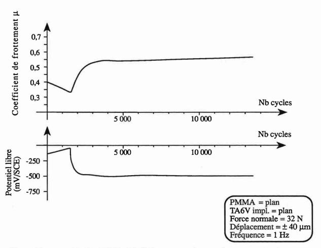
Figure 70 - Evolution du coefficient de frottement  $\mu$  et du potentiel de corrosion E en fonction du nombre de cycles après implantation ionique "classique" d'azote (TA6V implanté  $1.10^{17}$  at N/cm², 80~keV). Contact plan (PMMA) sur plan (TA6V impl.) .Solution de Ringer.
