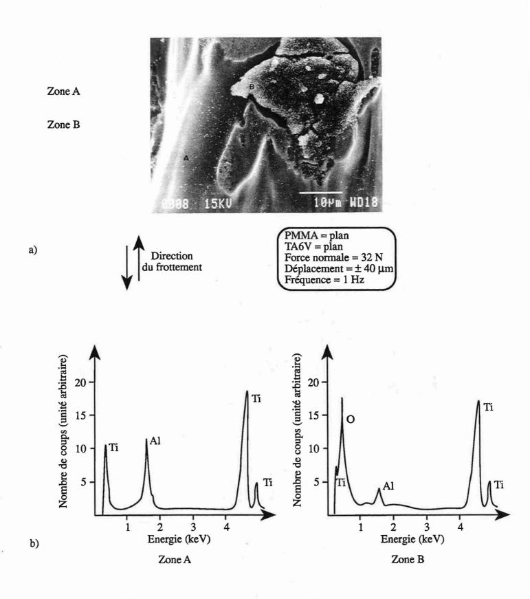
Figure 58 - Mise en évidence par micro-analyse X dispersive en énergie de la formation de particules riches en oxygène dans la tranchée de l'échantillon en TA6V.
