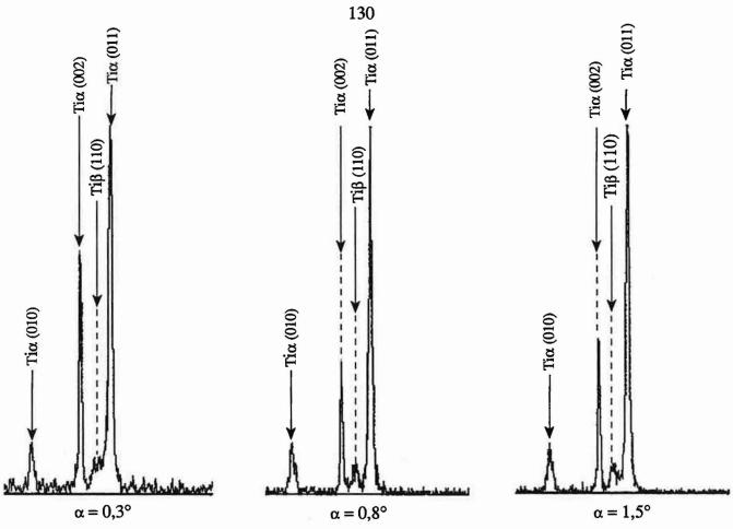
Figure 85 - Spectres de diffraction des rayons X en incidence rasante d'une surface en TA6V non traité. Domaine angulaire de  $2\theta = 33^{\circ}$  à  $2\theta = 46^{\circ}$ ;  $\lambda K\alpha$  Cu = 1,5418 Å; incidences  $\alpha = 0.3^{\circ}$ ,  $\alpha = 0.8^{\circ}$ ,  $\alpha = 1.5^{\circ}$
