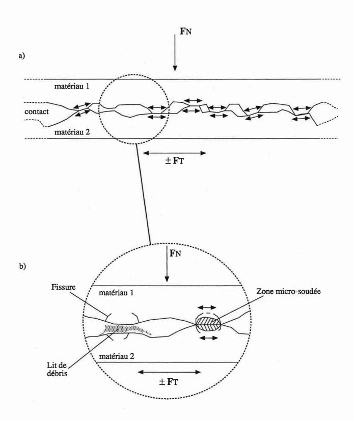
Figure 7 - Mécanismes de dégradation des surfaces.
