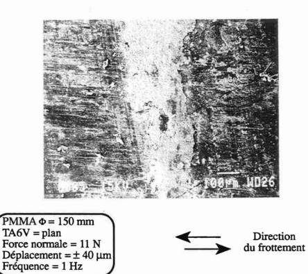
Figure 45 - Surface du PMMA après 100 000 cycles de fretting en solution de Ringer. Pression maximale de Hertz égale à 3 MPa Aspect du troisième corps, adhérant sur le cylindre et composé de débris de PMMA et de TA6V
