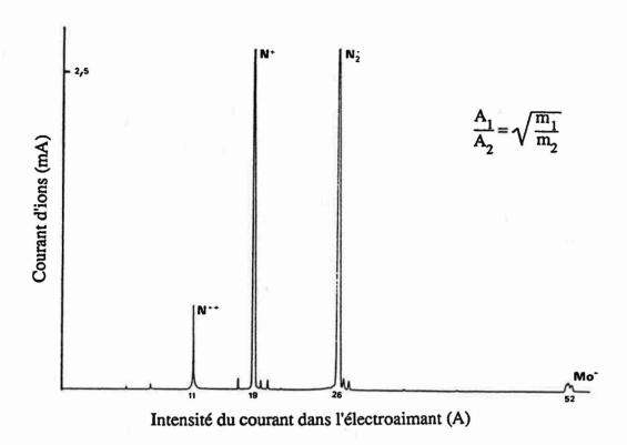
Figure 18 - Spectre de masse expérimental de l'azote
