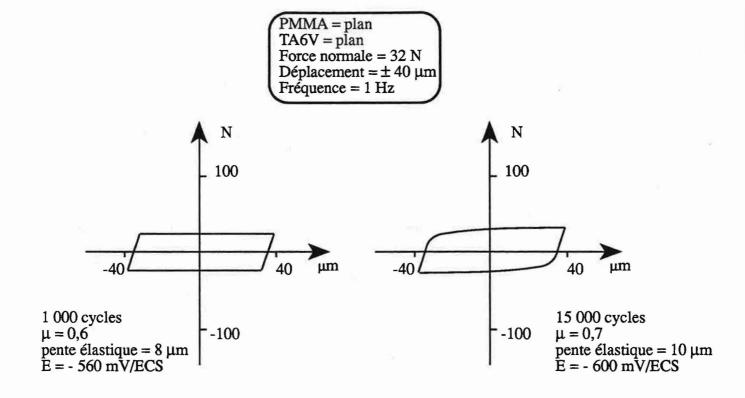
Figure 52 - Courbes FD à 1 000 et 15 000 cycles pour le contact plan (PMMA) sur plan (TA6V). Solution de Ringer
