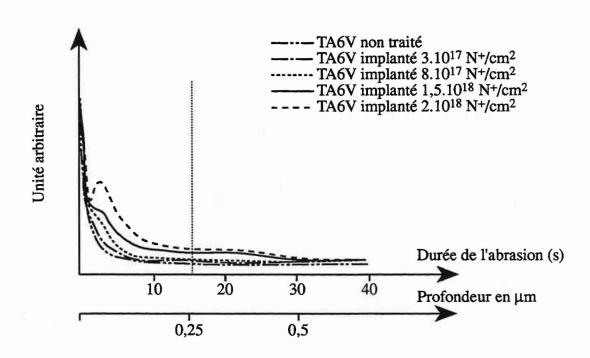
Figure 79 - Spectres SDL de la répartition en profondeur du carbone de pollution aprés implantaion d'aote à 120 keV dans du TA6V pour les différentes doses étudiées.
