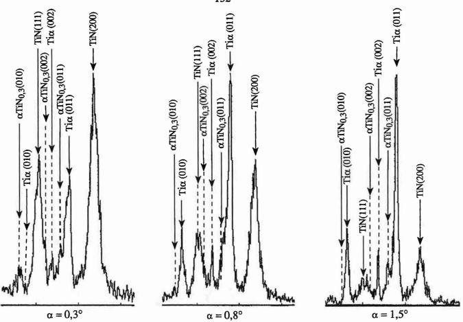
Figure 89 - Spectres de diffraction des rayons X en incidence rasante d'une surface en TA6V implanté  $2.10^{18}$  N<sup>+</sup>/cm<sup>2</sup>. Domaine angulaire de  $2\theta = 33^{\circ}$  à  $2\theta = 46^{\circ}$ ;  $\lambda K\alpha Cu = 1,5418$  Å; incidences  $\alpha = 0,3^{\circ}$ ,  $\alpha = 0,8^{\circ}$ ,  $\alpha = 1,5^{\circ}$
