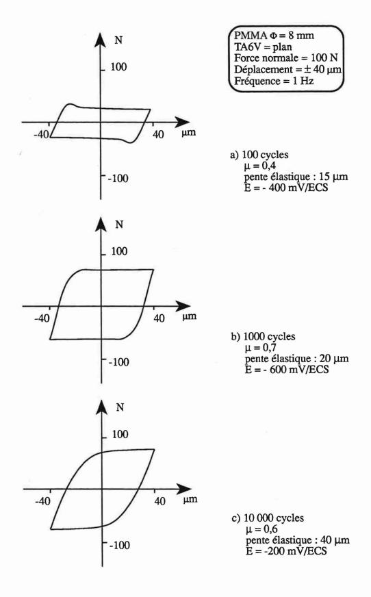
Figure 32 - Evolution de la forme des courbes FD en solution de Ringer. Pression maximale de Hertz égale à 45 MPa
