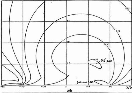
b- Contact soumis à une force normale et une force tangentielle. Coefficient de frottement  $\mu = 0.25$
