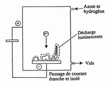
Figure 21 - Schéma de principe de la nitruration ionique d'après (76)
