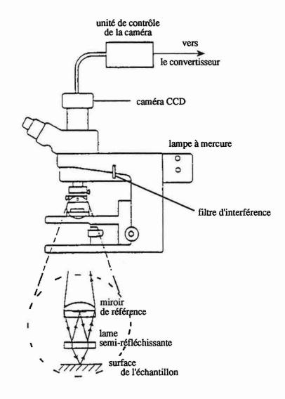
Représentation schématique du microscope par interférométrie optique
