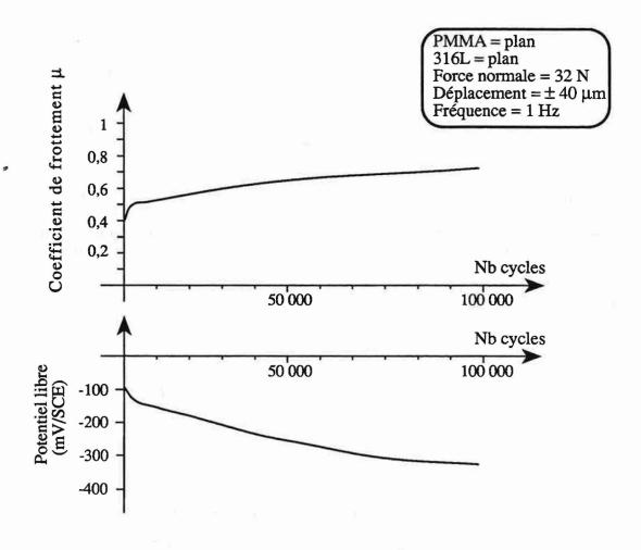
Figure 66 - Evolution du coefficient de frottement  $\mu$  et du potentiel de corrosion E en fonction du nombre de cycles. Contact plan (PMMA) sur plan (316L) . Solution de Ringer.
