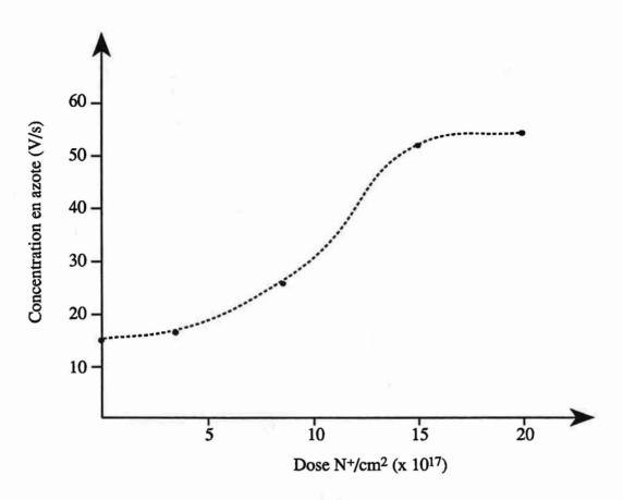
Figure 80 - Concentration en azote en fonction de la dose d'ions implantés (mesure de l'aire sous les pics SDL d'azote en V/s).
