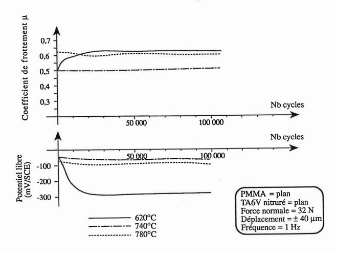
Figure 105 - Evolution du coefficient de frottement  $\mu$  et du potentiel de corrosion E en fonction du nombre de cycles après nitruration du TA6V à 620°, 740°, et 780°C. Contact plan (PMMA) sur plan (TA6V impl.) .Solution de Ringer.
