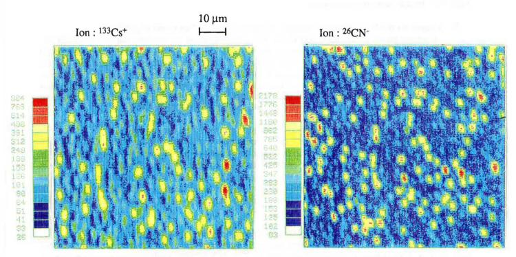
(b) Images ioniques de l'échantillon implanté  $1,5.10^{18} \, \text{N}^+/\text{cm}^2$ L'ion Cs+ décrit la structure. Mise en évidence de nombreux précipités (intensité de la sonde ionique :  $i_p = 4 \, \text{pA}$  [ion Cs+] et  $ip = 26 \, \text{pA}$  [ion CN-])
