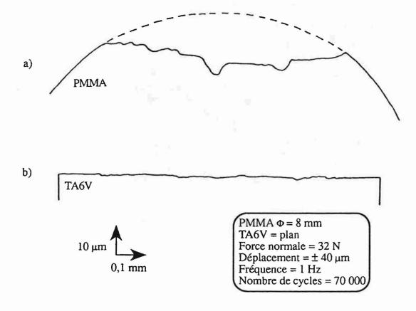
Figure 41 - Profils de rugosité après fretting en solution de Ringer
