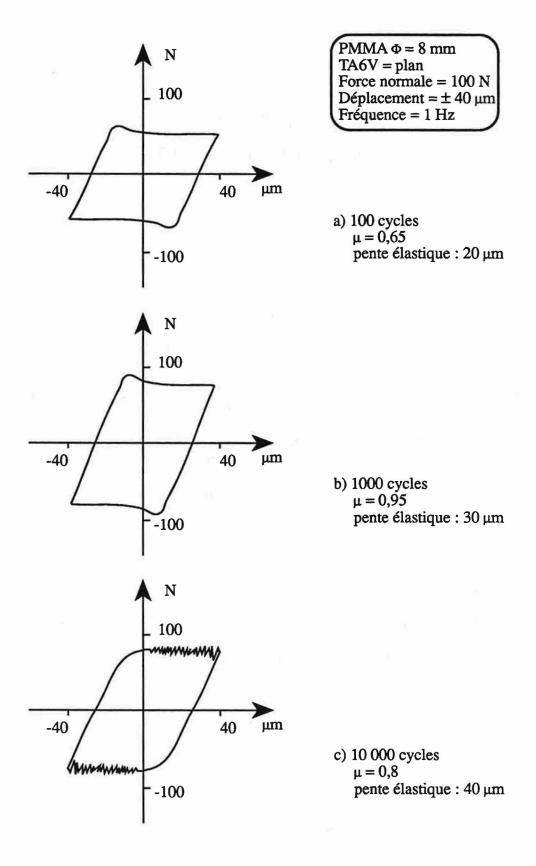
Figure 26 - Evolution de la forme des courbes FD en fretting à sec Essais sur Tribomines
