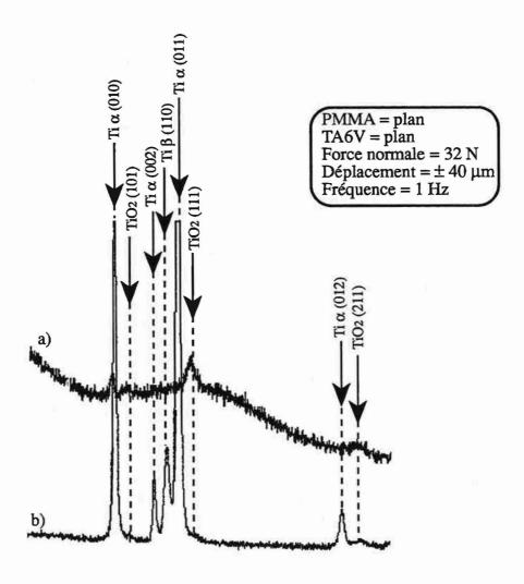
Figure 61 - Spectres de diffraction sur les échantillons en PMMA (a) et TA6V (b) dans le domaine angulaire  $2\theta = 38$  à  $68^{\circ}$  ( $\lambda = 1,7893$  Å, raie K $\alpha$  du Co), après 100 000 cycles de fretting en solution de Ringer.
