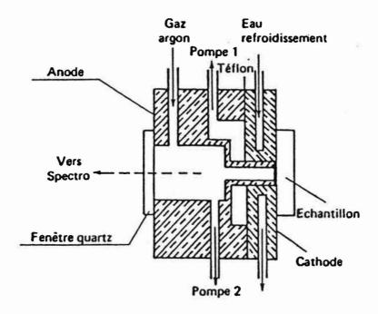
Figure 22 - Reprèsentation en coupe de la lampe à décharge luminescente (79)
