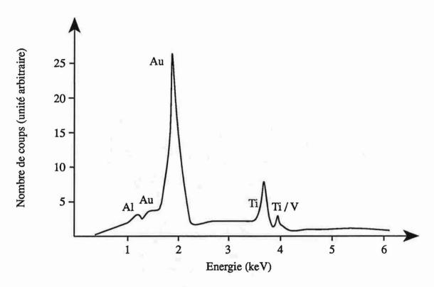
Figure 46 - Micro-analyse X dispersive en énergie de la zone de contact en relief sur le cylindre de PMMA mise en évidence de la présence de titane. (le pic parasite de l'or est dû au dépot réalisé pour l'observation au M.E.B.)
