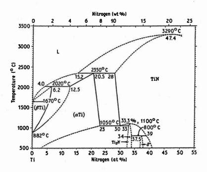
Figure 99 - Diagramme de phase Ti-N (102)
