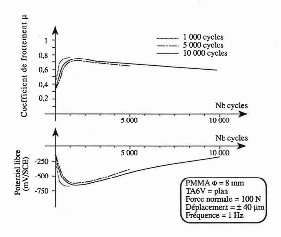
Figure 31 - Evolution du coefficient de frottement  $\mu$  et du potentiel de corrosion E en fonction du nombre de cycles. Contact cylindre (PMMA) sur plan (TA6V) . Solution de Ringer. Pression maximale de Hertz de 45 MPa
