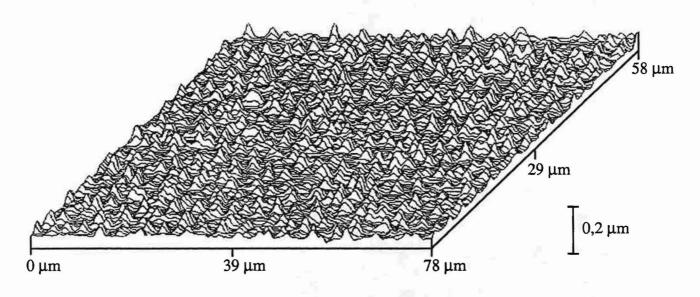
Figure 83 - Micro-relief 3D par profilométrie optique de la surface du TA6V implanté 1,5.10<sup>18</sup> N<sup>+</sup>/cm<sup>2</sup>· Le sommet des bulles est situé à environ 0,03 µm de la surface.
