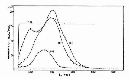
Figure 72 - Profils de concentration en azote obtenus par résonnance de la réaction nucléaire  $^{15}N$  (p,  $\alpha\gamma$ )  $^{12}C$  (mesure du taux de rayonnement  $\gamma$ émis). Les courbes (a), (b) et (c) correspondent respectivement aux doses de  $3.10^{16}$ ,  $1,3.10^{18}$  et  $3.10^{18}$  at. N/cm² ( implantation de  $N_2^+$  à  $300~{\rm keV}$ ). Pour comparaison, le profil de concentration obtenu pour un dépot PVD de TiN est également montré. (93)
