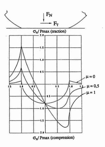
Figure 5 - Distribution des contraintes normales à la surface  $\sigma_x$  dans un contact cylindre / plan en glissement total d'après (22)
