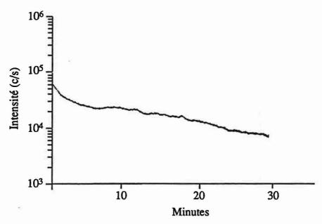
(a) Profil local de l'ion <sup>26</sup>CN<sup>-</sup> sur une zone en surintensité.
