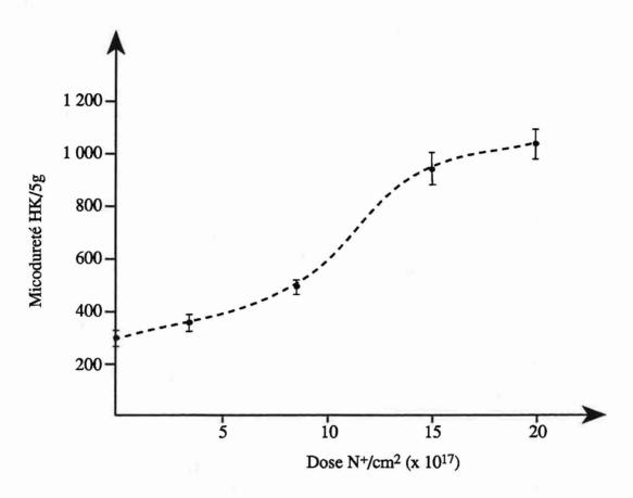
Figure 84 - Evolution de la microdureté Knoop sous 5 g du TA6V en fonction de la dose d'ions azote implantés.
