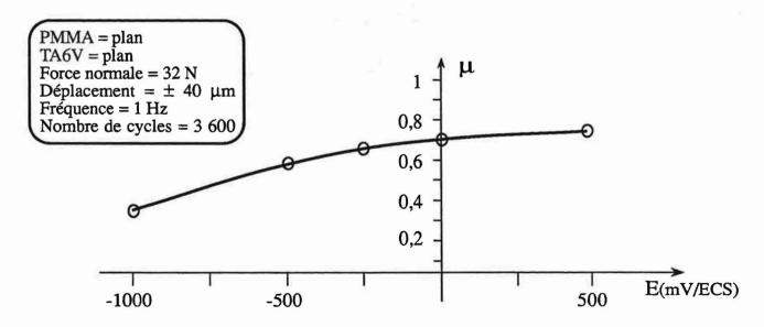
Figure 64 - Fretting à potentiel imposé. Evolution du coefficient de frottement en fonction du potentiel imposé après une heure de fretting
