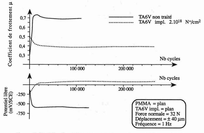
Figure 76 - Evolution du coefficient de frottement μ et du potentiel de corrosion E en fonction du nombre de cycles pour une surface en TA6V non traitée et implantée 2.10<sup>18</sup> N<sup>+</sup>/cm<sup>2</sup>.Contact plan (PMMA) sur plan (TA6V) .
