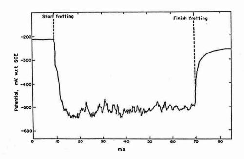
Figure 12 - Evolution du potentiel libre de corrosion dans un contact chrome/chrome en milieu chloruré. Sphère (diamètre 6,3 mm) sur plan,  $F_N=32~N,~\nu=120~Hz,~A=\pm\,25~\mu m~(52)$
