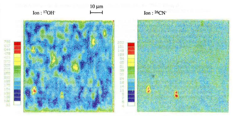
(a) Images ioniques de l'échantillon implanté  $8.10^{17}~\rm N^+/cm^2$  l'ion OH- décrit la structure. (intensité de la sonde ionique :  $i_p = 26~\rm pA$ )
