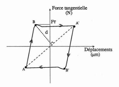
Figure 15 - Exemple de courbe force-déplacement
