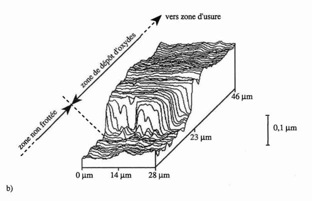
Figure 65 - Mécanisme du dépôt des oxydes métalliques en bordure de la zone de frottement. a) mécanisme électrochimique proposé. b) mise en évidence du dépôt par profilométrie optique
