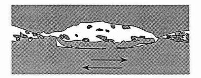
Ejection forte : les particules sont évacuées du contact, formation de copeaux.
