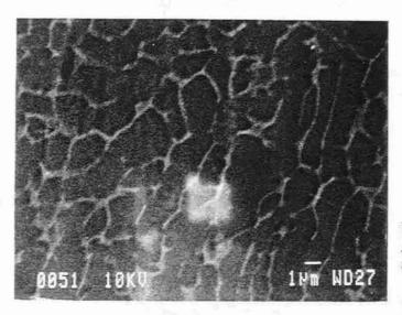
b) TA6V implanté 8.10<sup>17</sup> N<sup>+</sup>/cm<sup>2</sup> Aspect de la surface comparable au TA6V non traité.
