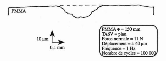
Figure 47 - Profil de rugosité du PMMA après fretting en solution de Ringer puis nettoyage à l'alcool méthylique dans un bac à ultra-sons. Décollement du 3° corps qui apparaissait en relief sur la figure 44a
