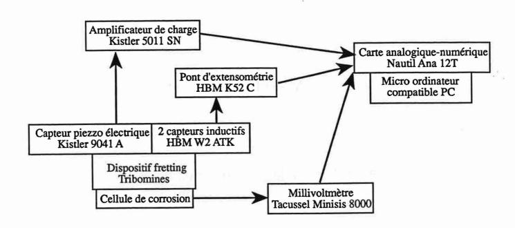
Schéma de principe de la chaine d'acquisition de donnée du dispositif Tribomines
