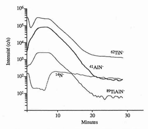
Figure 93 - Profils des ions  $^{14}N^{\text{-}}$ ,  $^{41}\text{AlN}^{\text{-}}$ ,  $^{62}\text{TiN}^{\text{-}}$  et  $^{89}\text{TiAlN}^{\text{-}}$  sur un échantillon en TA6V implanté  $8.10^{17}$  N+/cm². (source Cs+, mode négatif, intensité du faisceau d'ions primaires  $i_p$  = 250 nA, diamètre du champ analysé  $I_f$  = 250  $\mu m$ )
