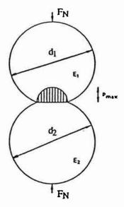
Figure 3 - Distribution de pression P dans un contact entre deux cylindres élastiques d'après (10)
