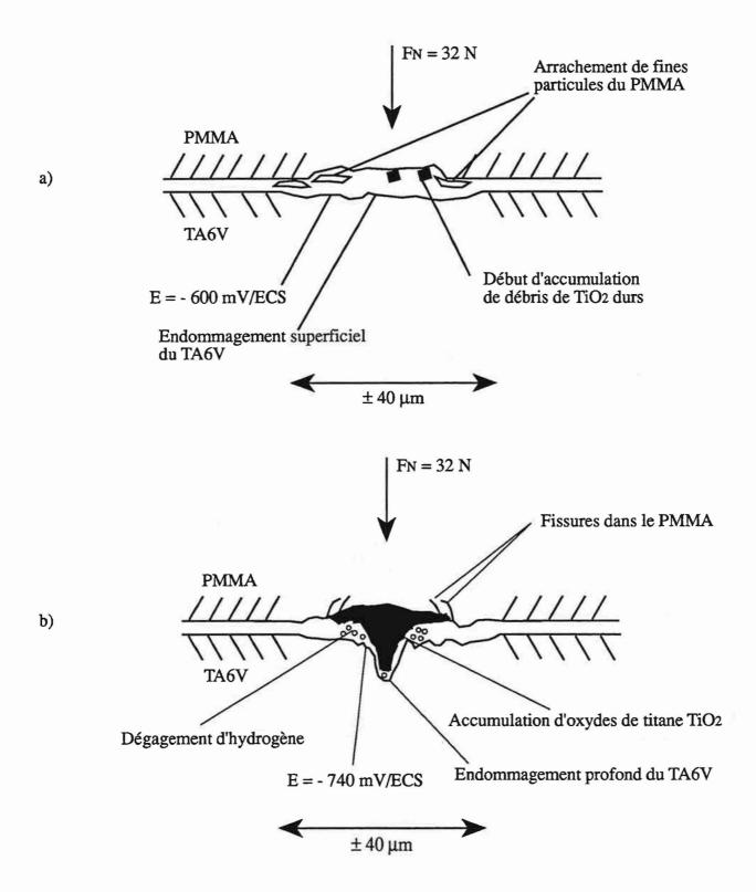
Figure 62 - Mécanisme de dégradation des surfaces dans un contact plan sur plan, TA6V / PMMA. a) Après 10 000 cycles de fretting. b) Après 100 000 cycles de fretting
