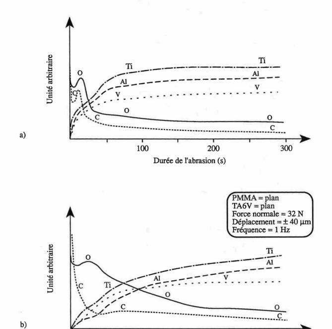
Figure 60 - Spectres SDL de la surface en TA6V. a) Echantillon témoin non frotté b) Echantillon après 100 000 cycles de fretting plan sur plan. Solution de Ringer
