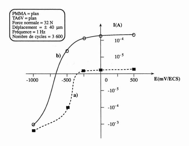
Figure 63 - Fretting à potentiel imposé. Evolution du courant de corrosion I en fonction du potentiel imposé E.
