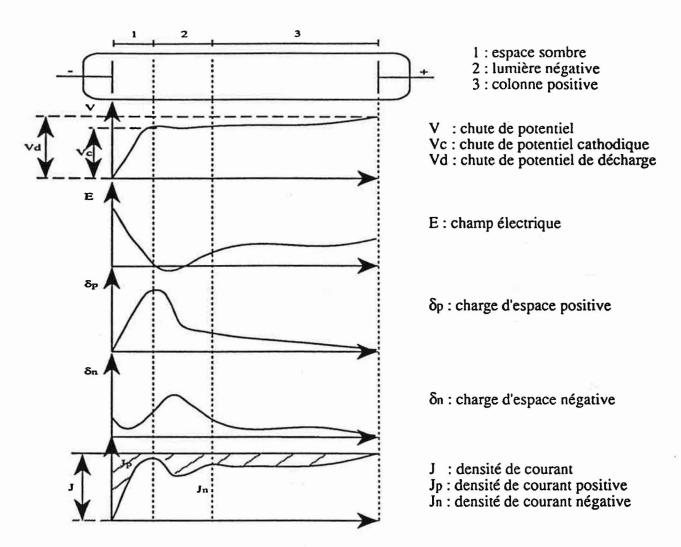
Figure 20 - Architecture de la décharge luminescente anormale d'après (74)
