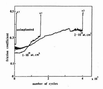
Figure 73 - Evolution du coefficient de frottement en fonction du nombre de cycles pour des surfaces non traitées et implantées à  $1.10^{18}$  et  $2.10^{18}$  at. N/cm<sup>2</sup> (implantation de N+ et N<sub>2</sub>+ à 80 keV; frottement sec bille acier ( $\Phi = 5$  mm) sur disque TA6V, 125 cycles/min  $\approx$  130 mm/s, 1 N). (91)
