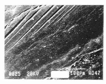
c) Même cylindre que précédement. Détail des fissures en bordure du contact avant enlèvement de particules.
