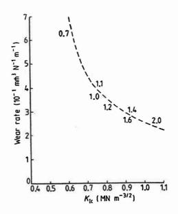
Figure 10 - Variation du taux d'usure avec le K<sub>IC</sub> pour des résines à différents degrés de réticulation. Contact acier-polymère. Les valeurs sur la courbe correspondent aux rapports amine/epoxy qui définissent les taux de réticulation (36)
