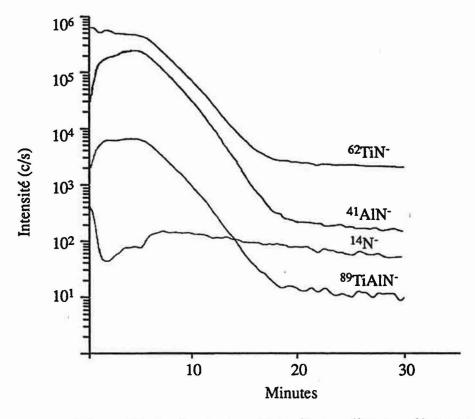
Figure 97 - Profils des ions  $^{14}N^{-}$ ,  $^{41}AlN^{-}$ ,  $^{62}TiN^{-}$  et  $^{89}TiAlN^{-}$  sur un échantillon en TA6V implanté 1,5.10 $^{18}$  N+/cm<sup>2</sup>. (source Cs+, mode négatif, intensité du faisceau d'ions primaires  $i_p = 250$  nA, diamètre du champ analysé  $I_f = 250$   $\mu$ m)
