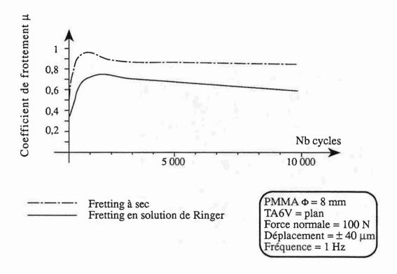
Figure 36 - Comparaison du coefficient de frottement sur 10 000 cycles à sec et en solution de Ringer
