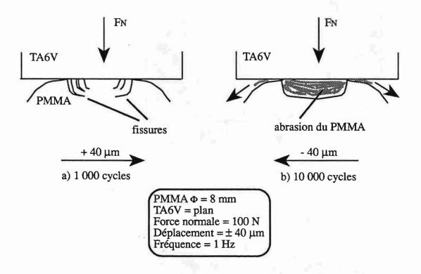
Figure 34 - Mécanisme d'amorçage des fissures puis d'enlèvement de particules dans le contact cylindre (PMMA) sur plan (TA6V) en solution de Ringer.
