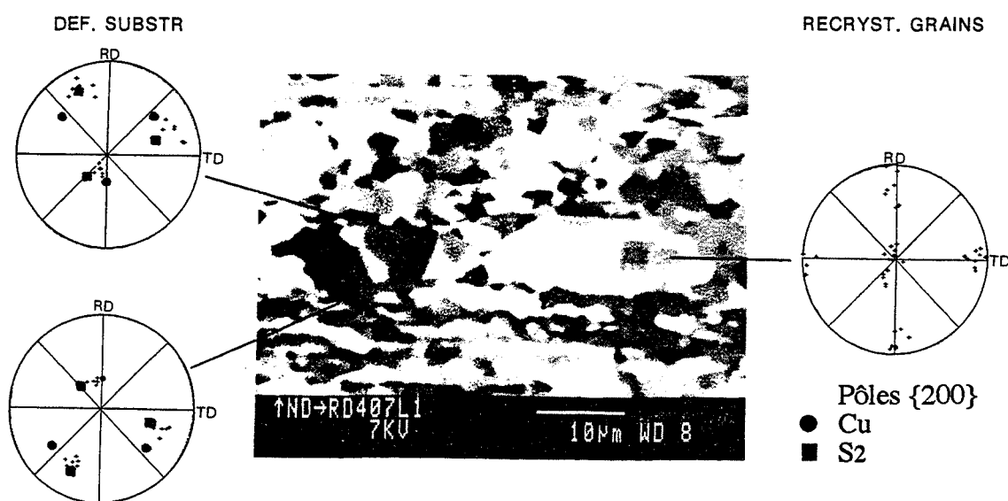
Figure IV.20 : Micrographie montrant la germination dans les bandes de transition dans des polycristaux d'aluminium laminés et recuits (cas FDL), d'après Hejelen et al. , (1991).
