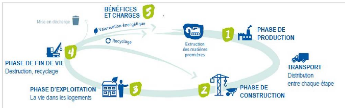
Le cycle de vie d'un bâtiment (Ministère de la transition écologique et de la cohésion des territoires, 2020)
